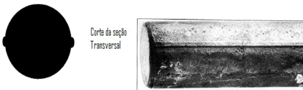
Figura 3.28 – Aspecto do defeito bigode em fio-máquina [manual de defeitos da A.I.S.I – Technical Committee on Rod and Bar Mills].
