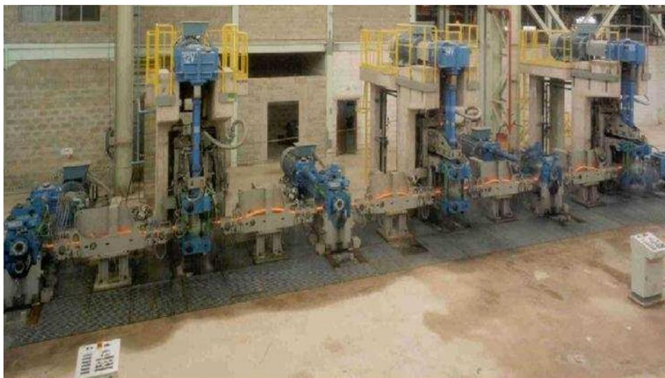
Figura 3.3 – Foto de um laminador contínuo de fio-máquina.
