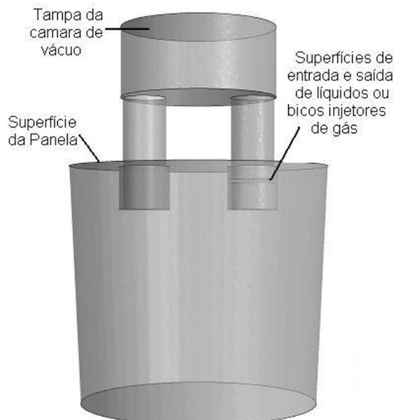
Figura 4.1 – Vista esquemática do RH indicando as superfícies citadas nas condições de contorno.
