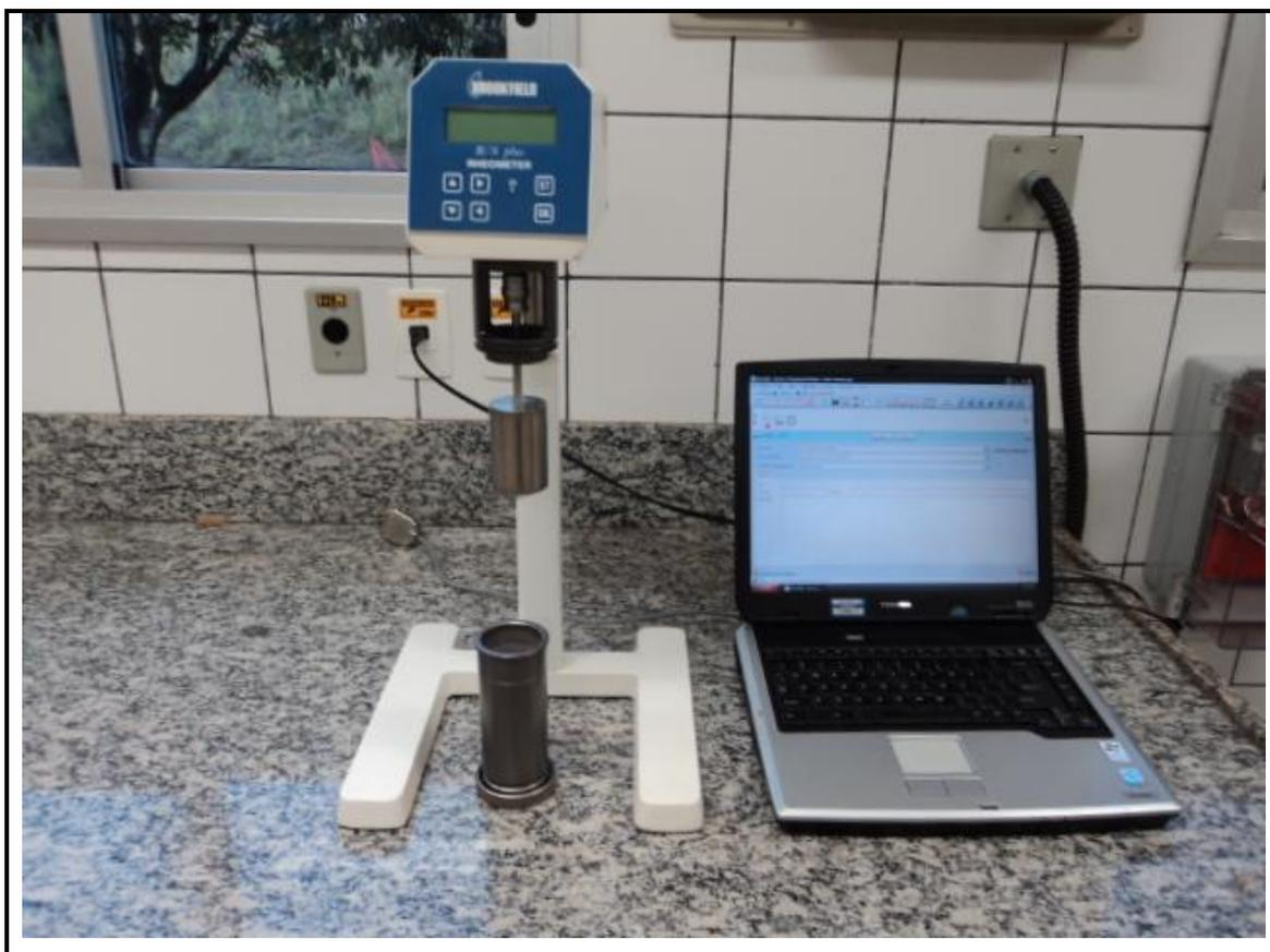
Figura 4.3 - Reômetro de cilindro coaxial utilizado no estudo.
