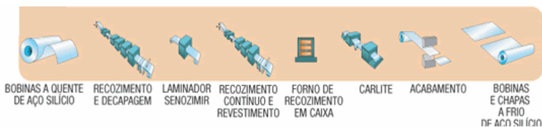
Figura 3.15 – Fluxo de fabricação do aço elétrico de grão orientado nas fases de laminação a frio e acabamento.
