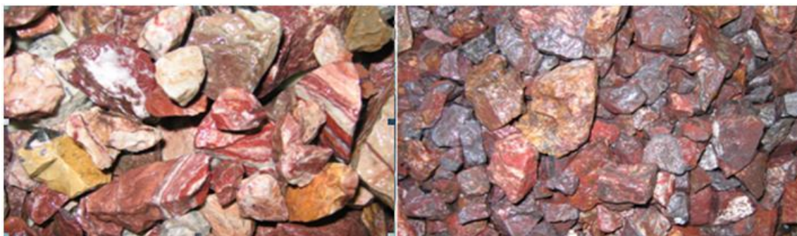
Figura 5.1. Flutuado em teste de meio-denso, à esquerda, contendo basicamente calcário dolomítico, e afundado, à direita, contendo willemita e hematita, tamanho máximo de 60 mm (LTM-USP).
