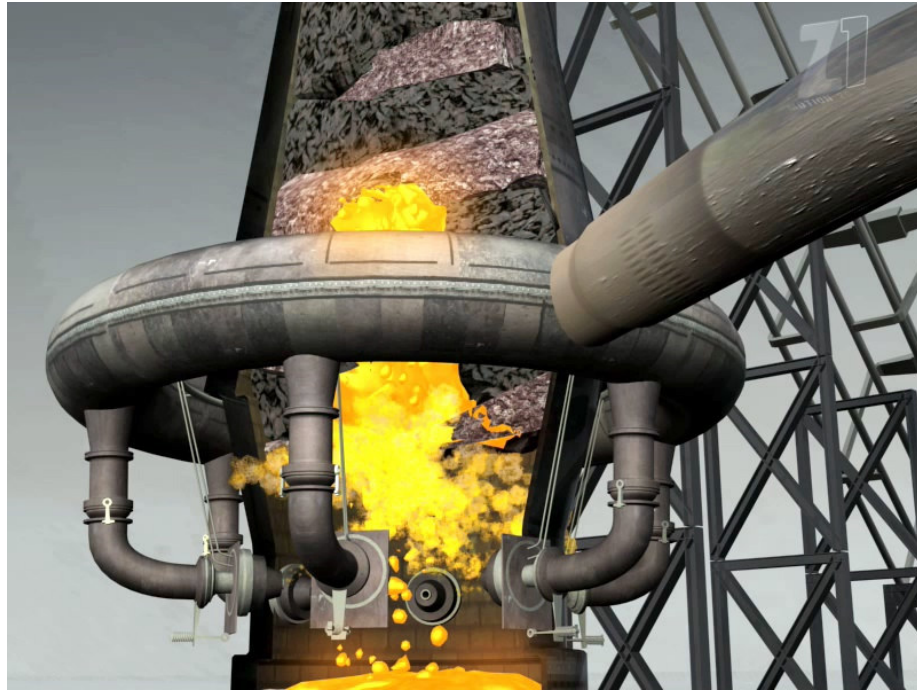
FIGURA 07 – Sistema de ventaneiras no alto-forno. Fonte: Metalsider Ltda/Z1 Motion, 2010.
