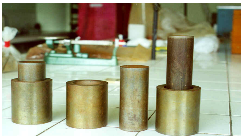
FIGURA 20 – Moldes de aço carbono para confecção dos corpos de prova. Fonte: Próprio autor.
