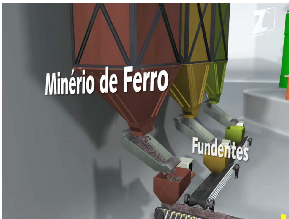
FIGURA 03 – Esquema do preparo da carga sólida para introdução no alto-forno. Fonte: Metalsider Ltda/Z1 Motion,2010.
