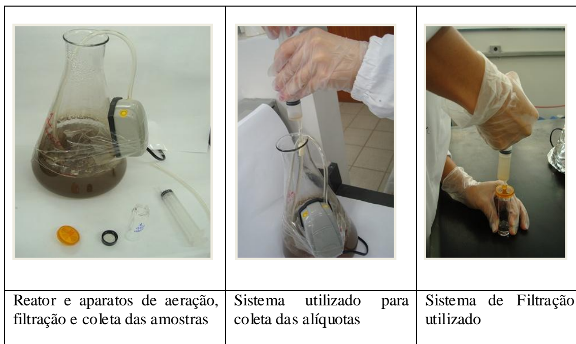
Figura 31 Fotos do sistema utilizado na biodegradabilidade aeróbia
