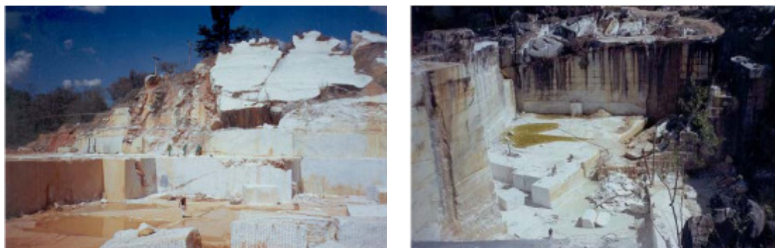
Figura 3-5 Lavra em fossa (esquerda) e poço (direita) (da Mata, 2003).
