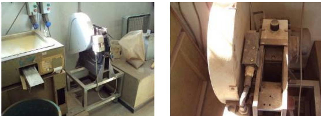
Figura 4-1 Fotos do britador de mandíbula usado nos ensaios – DEMIN/UFMG.
