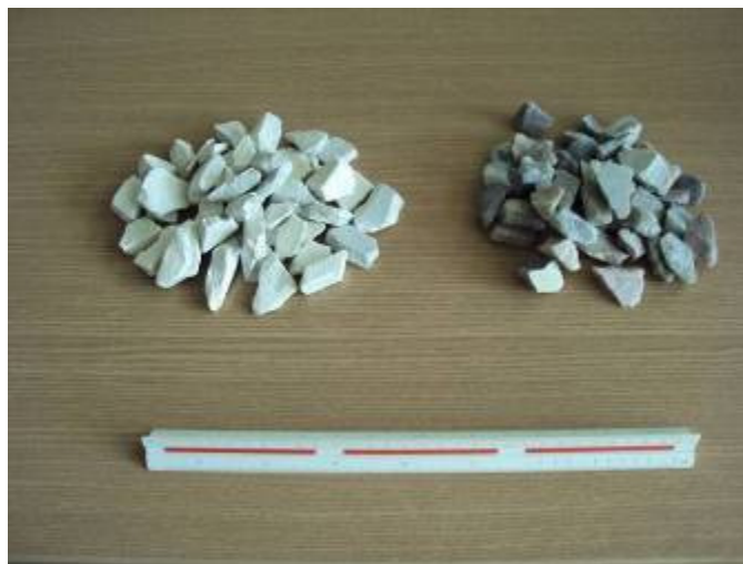
Figura 4-3 Amostras de rejeito de quartzito de grau de sanidade médio (esquerda) e grau de sanidade elevado (direita) submetidas a ensaios de absorção de água.
