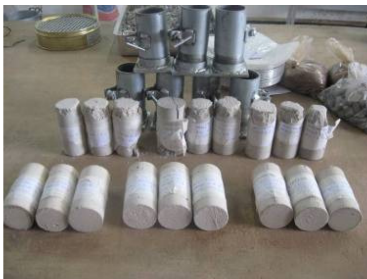
Figura 4-6 Moldes e corpos de prova para ensaio de resistência à compressão em argamassas.
