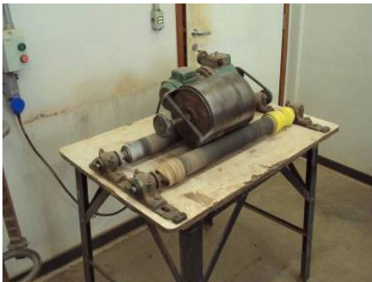
Figura 4-2 Foto do moinho usado nos ensaios – DEMIN/UFMG.
