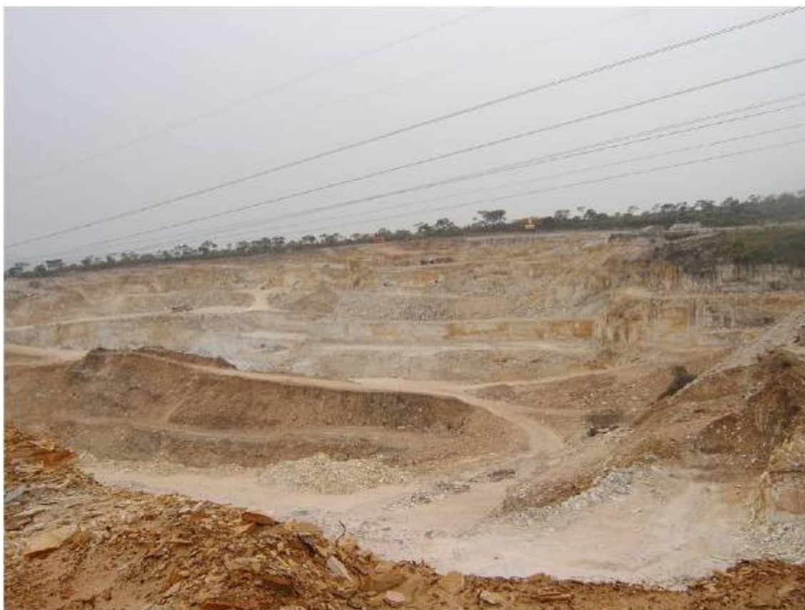
Figura 3-33 Frente de lavra de grande porte para extração de quartzito foliado na região de Alpinópolis (CPRM, 2007).
