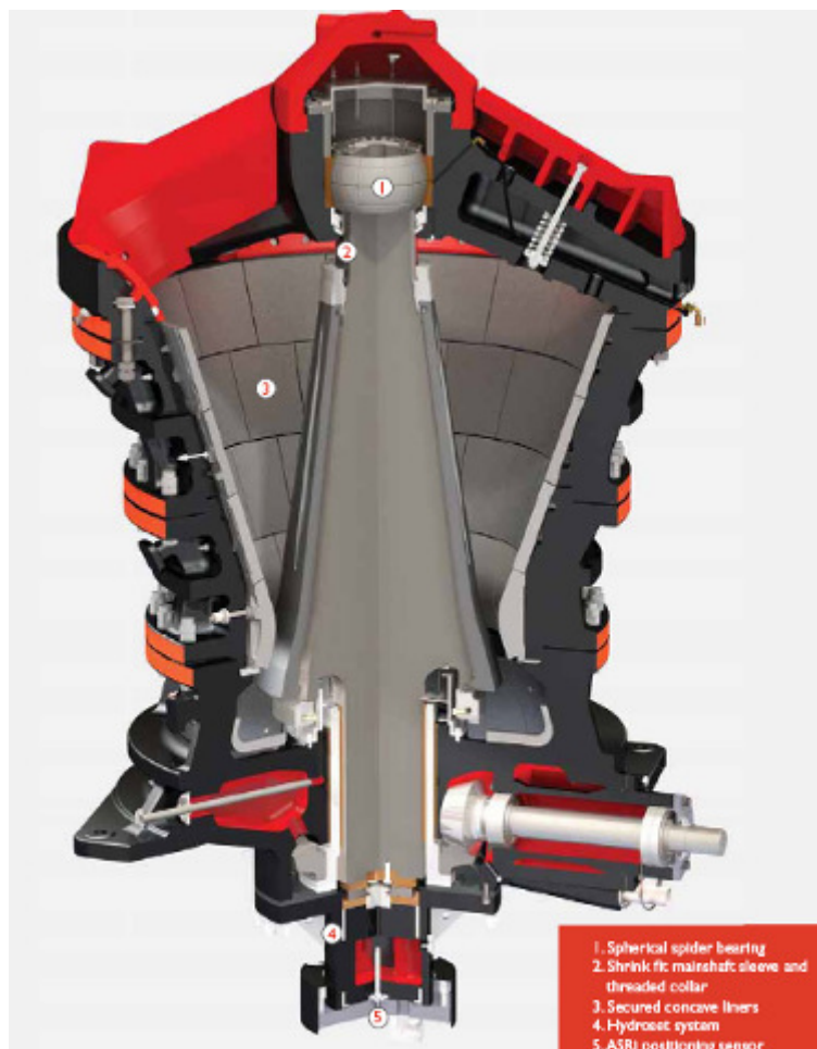
Figura 3-42 Corte de um britador giratório. Fonte: www.sandvik.com – acessado em 17-08-2011
