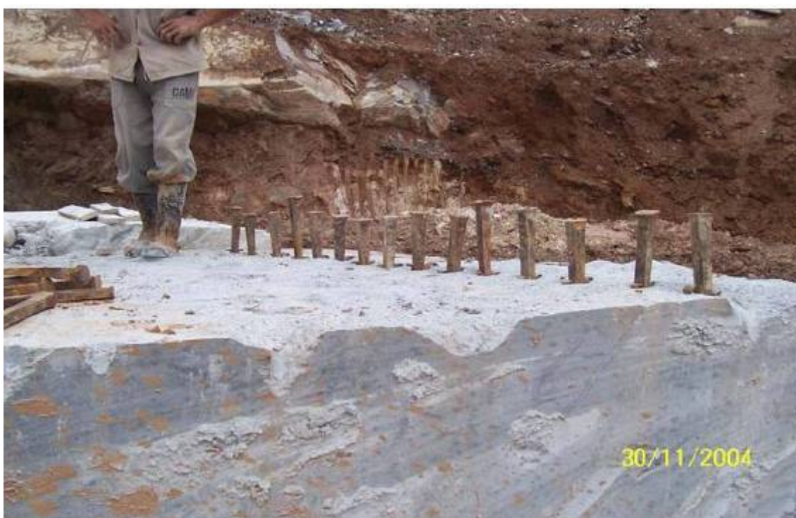
Figura 3-14 Colocação de cunhas para corte em esteatito (Almeida, 2006).
