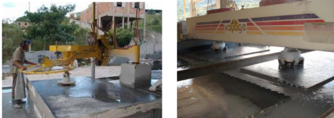
Figura 3-18 Máquinas de polimento manual (esquerda) e automático (direita) usadas no beneficiamento do quartzito extraído em Ouro Preto (Pires, 2007).
