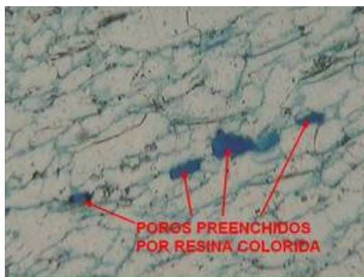
Figura 5-3 Quartzito de grau de sanidade médio com indicação de porosidade – Comprimento de quadro de 0,940 mm.
