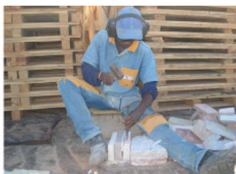
Figura 3-17 Extração e corte de placas em quartzito foliado (Pires, 2007).
