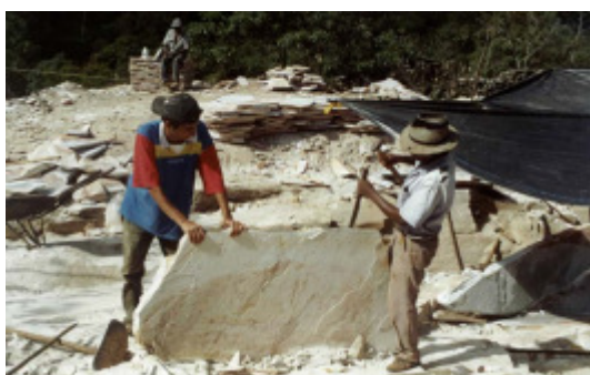
Figura 3-17 Extração e corte de placas em quartzito foliado (Pires, 2007).
