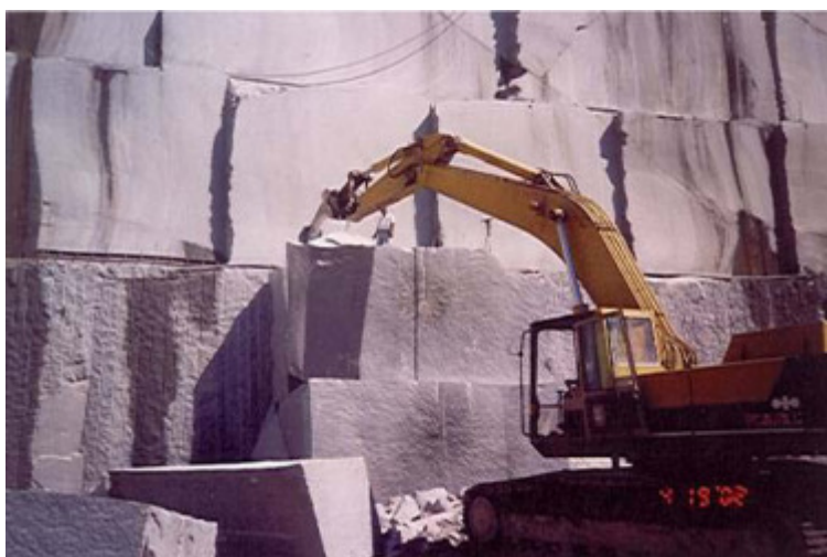
Figura 3-10 Lavra por degraus - Degraus múltiplos (Instituto Geológico Mineiro).
