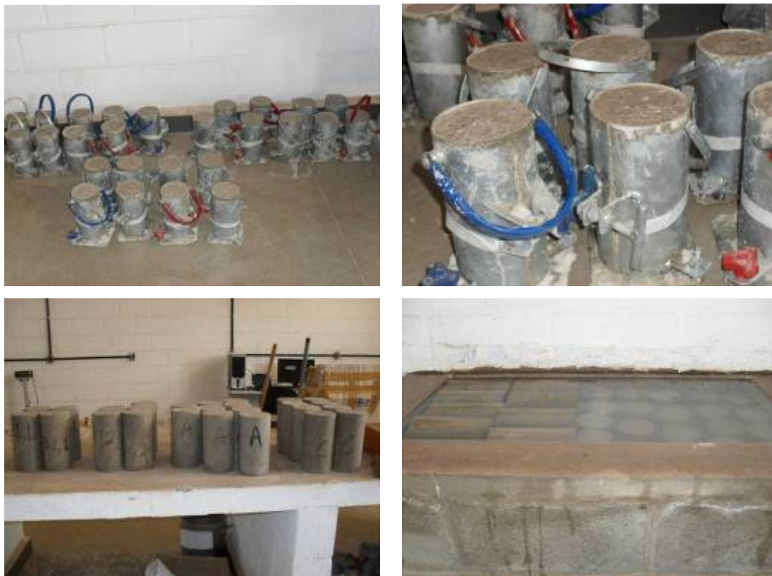
Figura 4-4 Corpos de prova moldados com quartzito como agregado (corpos de prova nos moldes, desmoldados e em cura por imersão)
