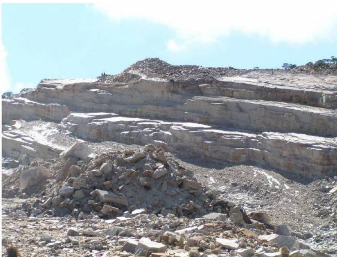
Figura 3-32 Lavra em bancada executada em mineradora na serra da Canastra (Valadão et al, 2010).
