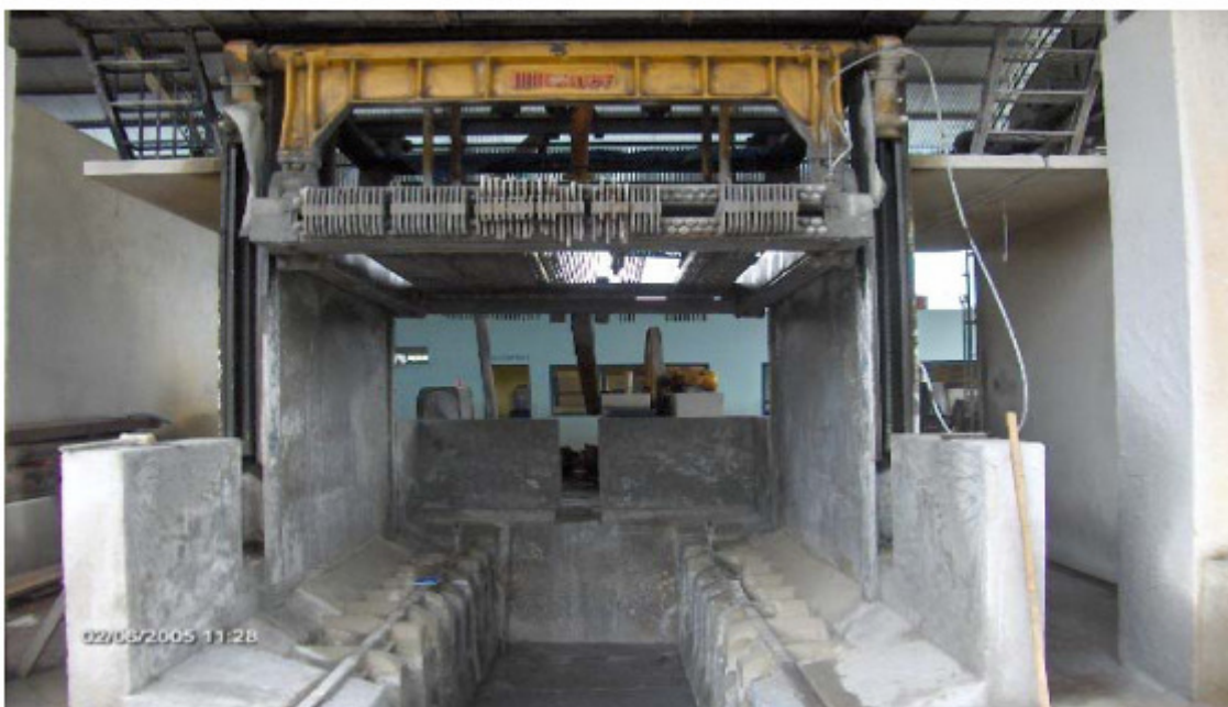
Figura 3-15 Tear multi-lâminas utilizado no corte de rochas ornamentais (Coimbra Filho, 2006).
