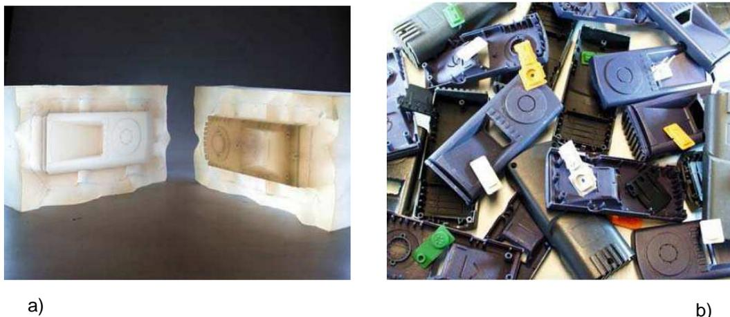
Figura 12 – a) Molde PR em estereolitografia;
