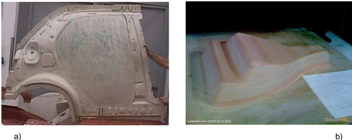
Figura 14 – a) Molde para laminação da parte traseira do painel lateral interno de uma carroceria; b) Molde para termoformagem da tampa do acento da motocicleta.
