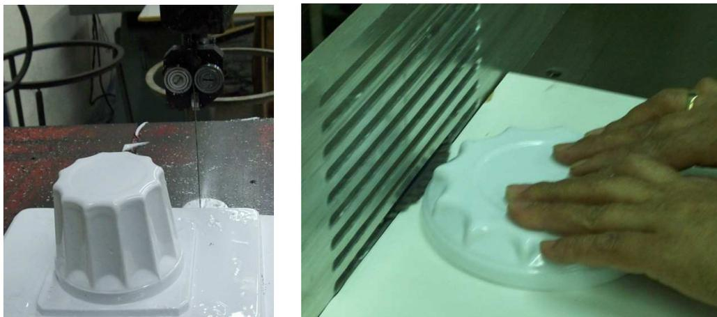
Figura 57 – a) Fabricação: corte do excesso de material;
