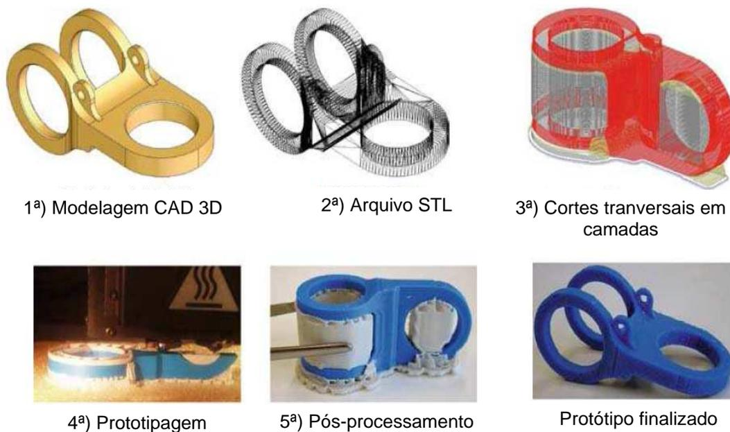
Figura 10 - Representação das etapas do processo de prototipagem rápida.
