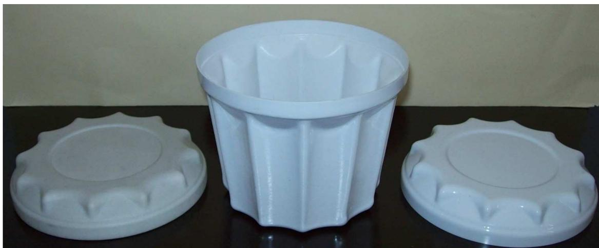
Figura 58 – Produtos testados: esquerda produto RP e direita produto fabricado.
