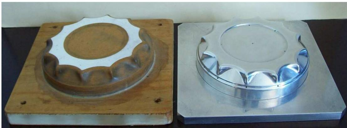
Figura 61 – Moldes fabricados: na esquerda em madeira e direita em alumínio.
