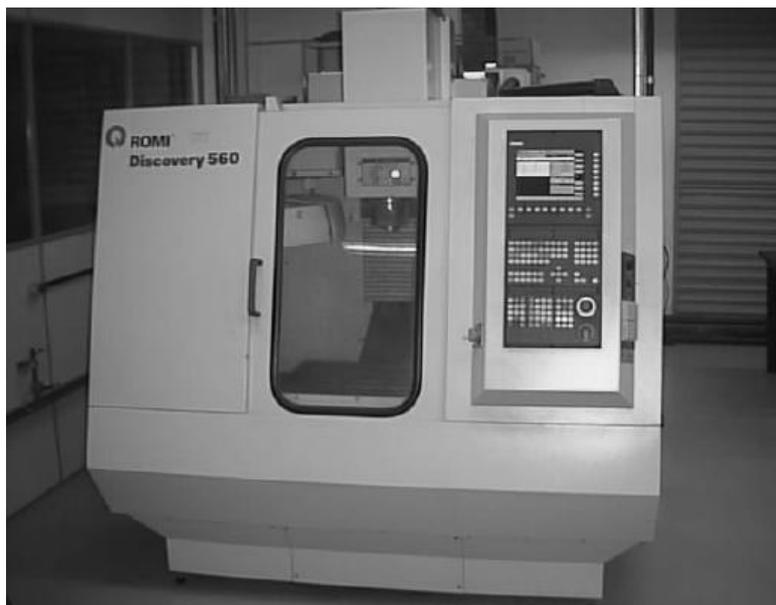
Figura 3.2 – Centro de usinagem Romi Discovery 560
