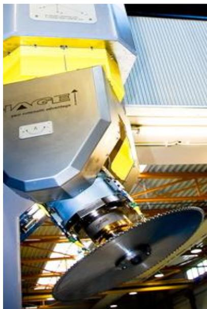
Figura 2.4 – Detalhe da serra montada na máquina
