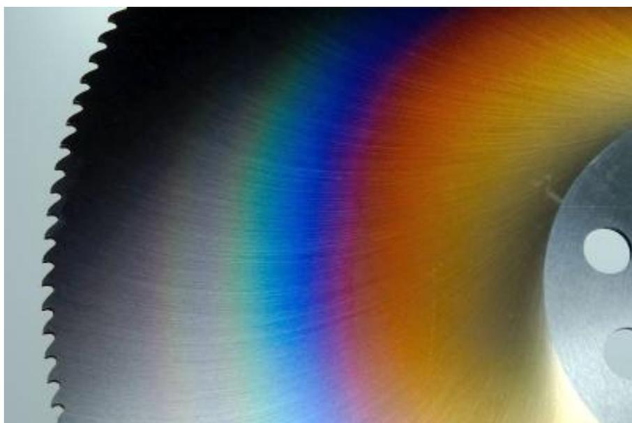
Figura 2.10 – Serra circular de aço rápido revestida com TiAlN
