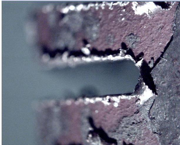
Figura 4.40: Rebarbas aderidas ao final do corte geradas pelas serras (a) cermet, (b) MD S e (c) MD VN ( $v_c= 140$  m/min e  $f_z= 0,07$  mm/rev). Largura das fendas de aproximadamente 2 mm (cont.)
