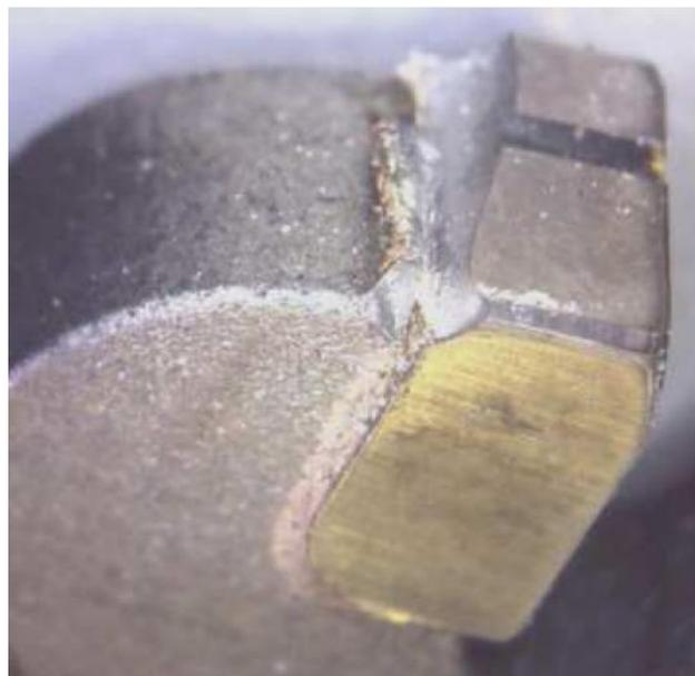
Figura 2.29 – Desgaste o lascamento no inserto de metal duro P20 após 100 cortes
