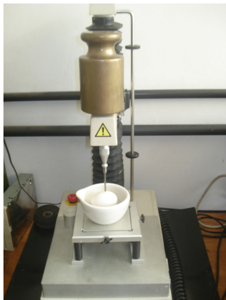
Figura 2- Equipamento TA.XT2 Texture Analyser utilizado para a realização do teste de fratura por compressão para medir a força da casca dos ovos
