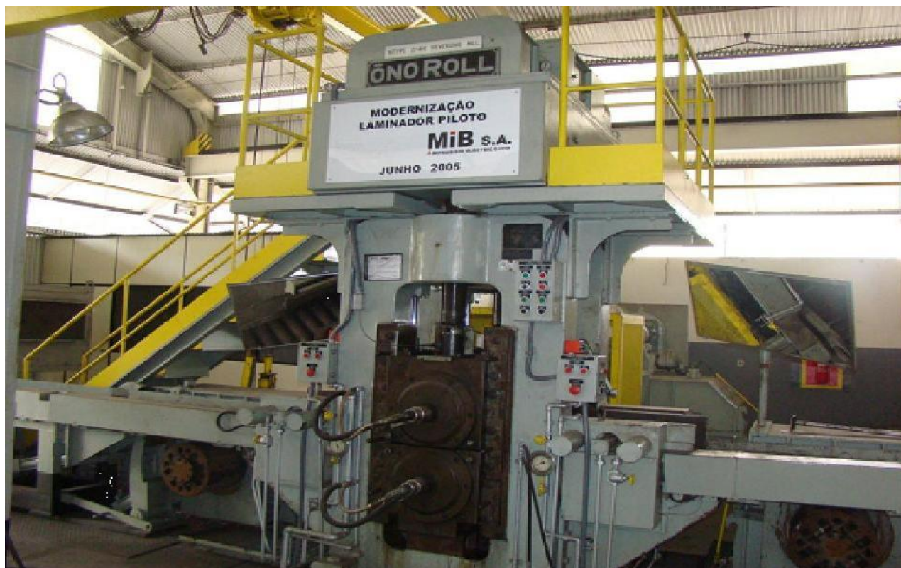
Figura 4.5- Fotografia do laminador piloto do centro de pesquisas
