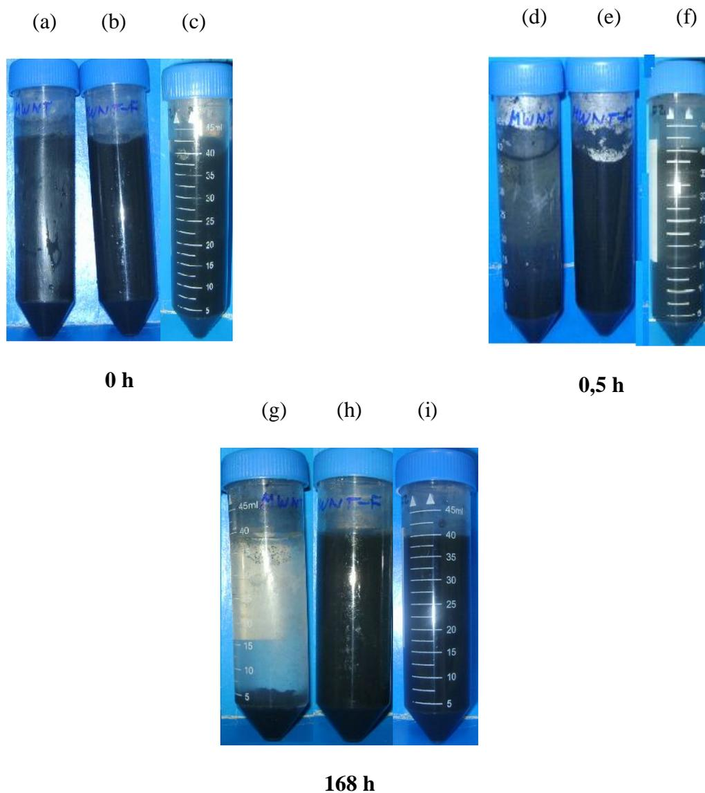
**Figura 5.10** Dispersões aquosas dos nanotubos de carbono de paredes múltiplas não funcionalizados (a), (d), (g), funcionalizados por F1,  $\text{HNO}_3$  (b), (e), (h) e funcionalizados por F2  $\text{HNO}_3/\text{H}_2\text{SO}_4$  (c), (f), (i), logo após a retirada dos frascos do ultra-som; após 0,5h e após 168h (sete dias) da retirada dos frascos.
