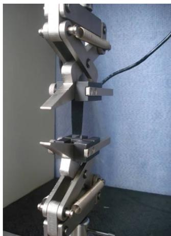
**Figura 4.4** Amostra de nanocompósito sob ensaio de tração.
