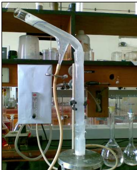
Figura 3.4: Tubo de Hallimond adaptado com prolongamento de 20 cm.
