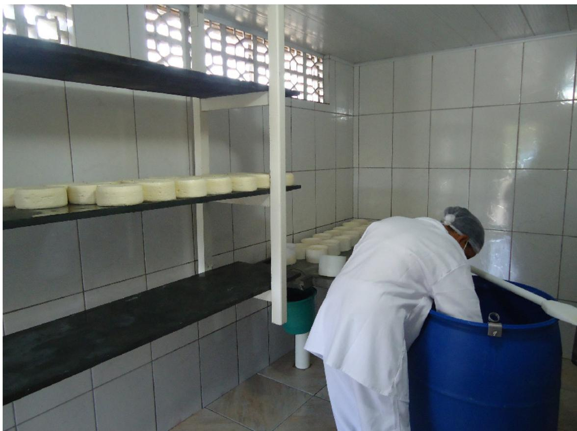
FIGURA 24 - Processo de dessoração e enformagem da massa
