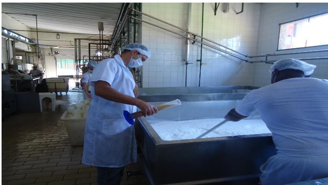
FIGURA 20 - Processo de dessoração e enformagem da massa
