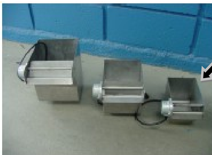
Figura 4.4 – Conjunto de cubas que podem ser utilizadas na célula de flotação modelo CFB 1000N de fabricação da Engendrar com destaque para a cuba de 700 cm 3 de volume útil.
