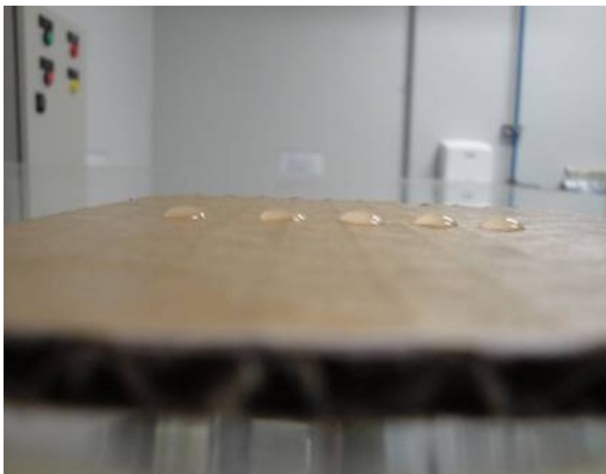
Figura 5.8 – Gotas aplicadas sobre o papelão sem revestimento para medição do ângulo de contato
