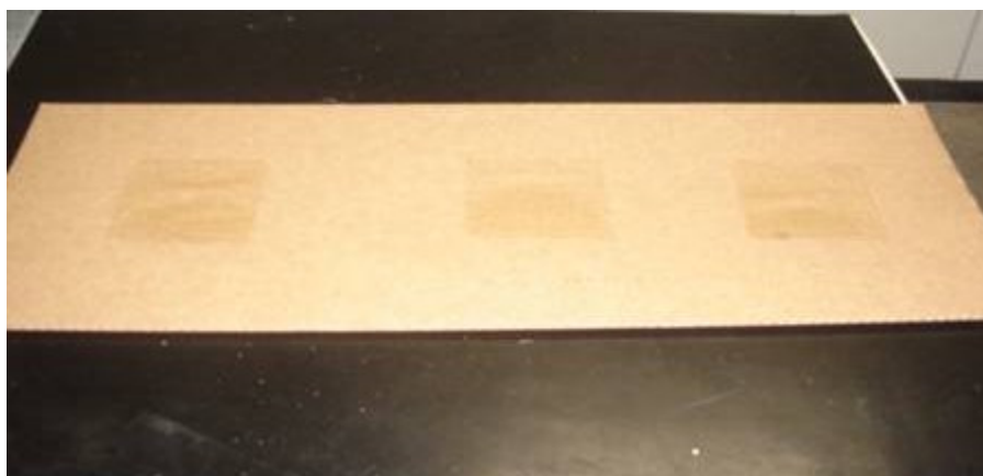
Figura 5.1 – Papelão com aplicação de filme de quitosana
