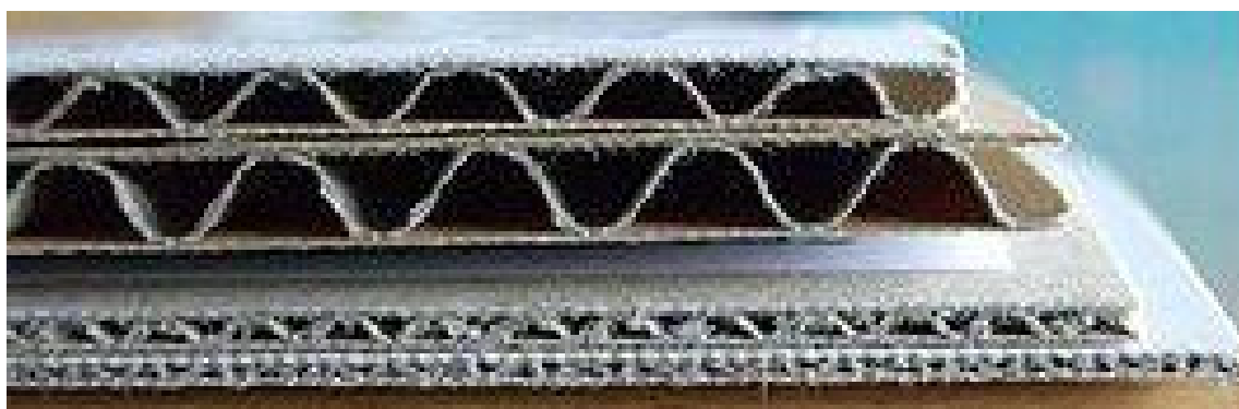
Figura 3.8 – Composição de uma chapa de papelão ondulado
