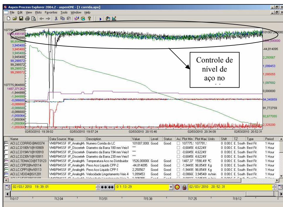
Figura 5.26. Gráfico de controle de nível de aço no molde para uma corrida utilizando a escória B.
