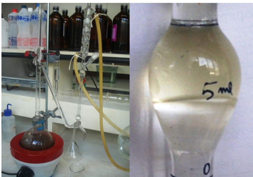
Figura 11 - Obtenção de óleo essencial por hidrodestilação (OEXA)
