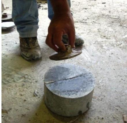
FIGURA 32 – Fixação da placa ao bloco na UPA B
