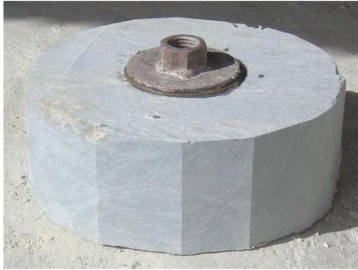
FIGURA 28 – Base de ferro acoplada ao bloco “sextavado”
