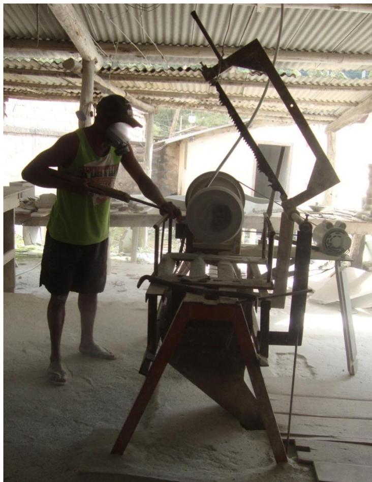
FIGURA 29 – Torneamento da panela na UPA A
