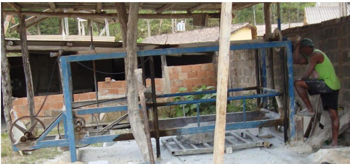
FIGURA 22 – Serragem do bloco na UPA A
