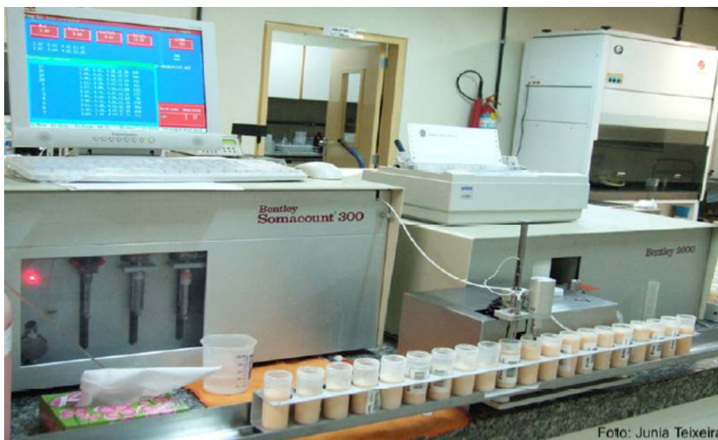
Figura 3. Foto do equipamento eletrônico Somacount 300 da Bentley Instruments Incorporated®, Chaska, Estados Unidos da América, para contagem de células somáticas em amostras de leite cru.
