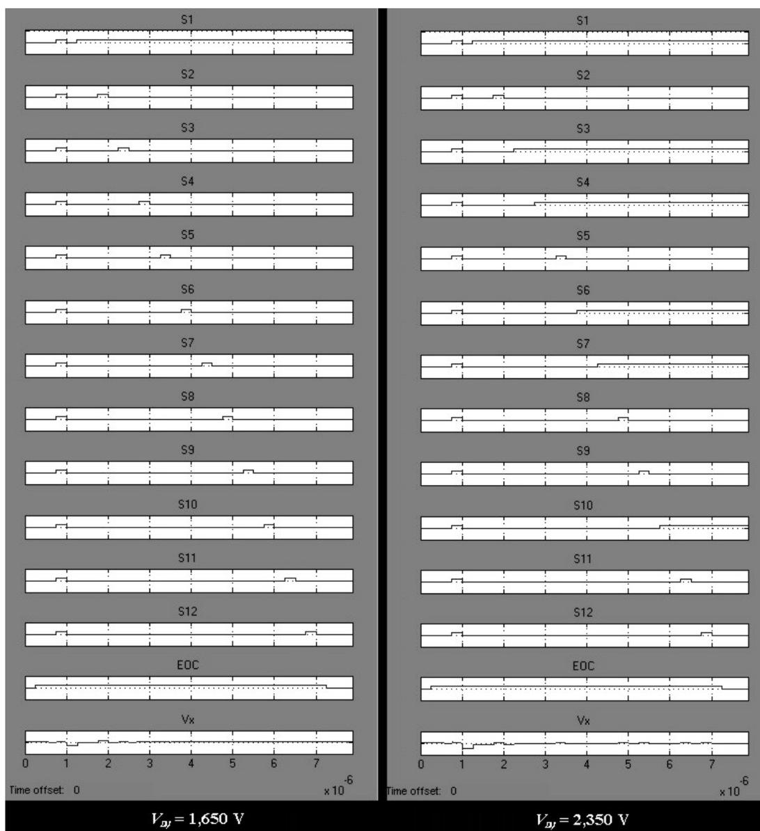
Figura 7.1: saída do conversor para valores de entrada  $V_{IN} = 1,650$  e  $2,350\text{ V}$ .
