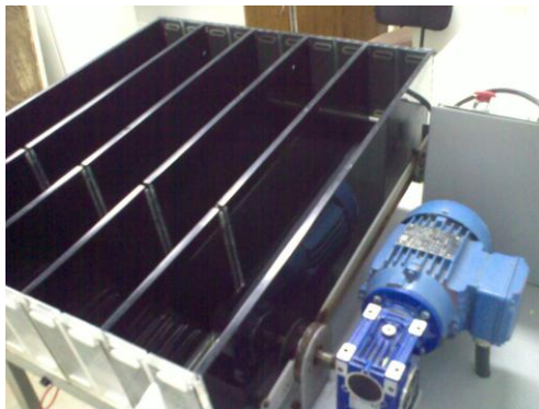
Fig. 4. Esteira utilizada para aclimação, avaliação e exercício físico dos ratos – ver texto para maiores detalhes. Fonte: arquivo pessoal.
