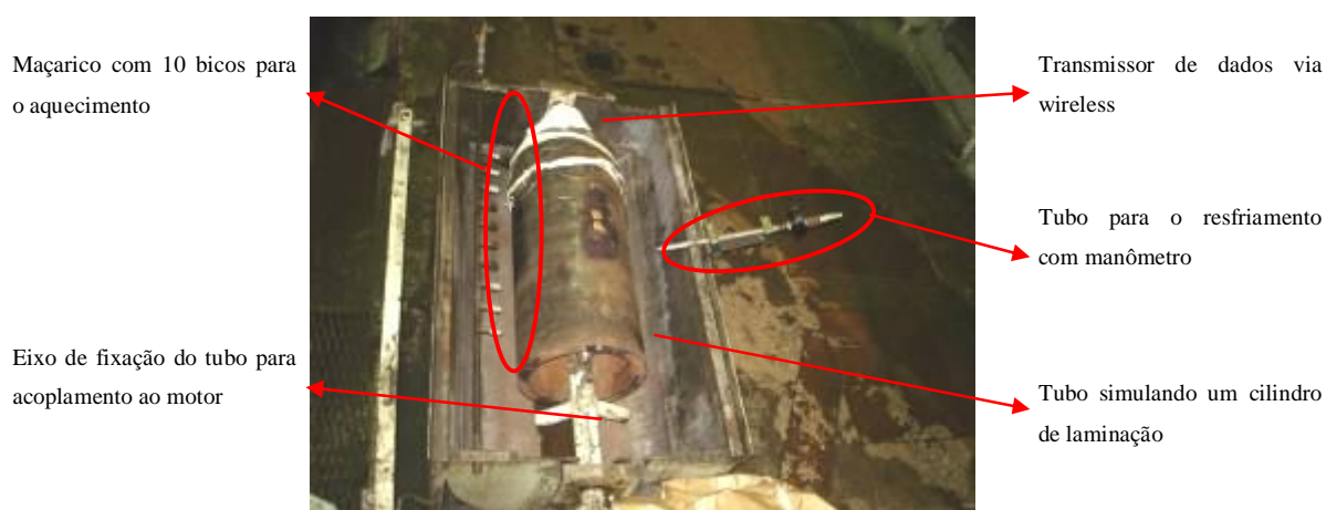
Figura 4.2 – Montagem do aparato experimental para estudo do resfriamento.
