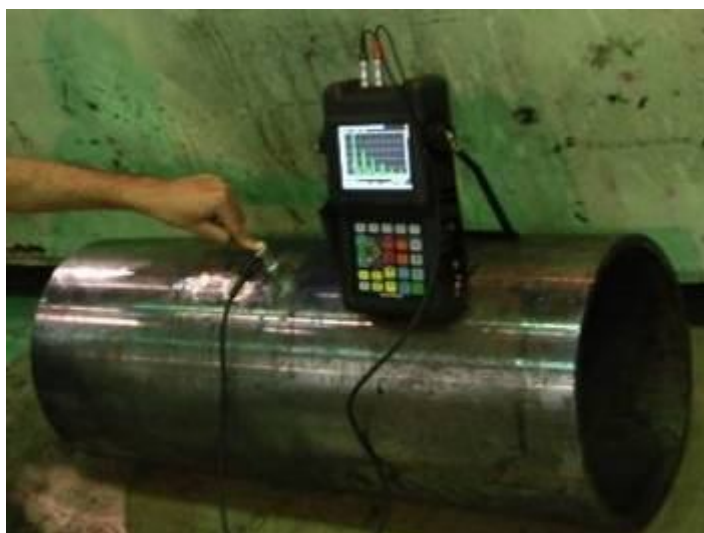
Figura 4.8 – Aparelho de ultrassom usado para conferir o posicionamento e a profundidade dos furos.
