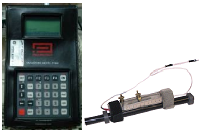
Figura 4.13 – Medidor de vazão por ultrassom usado no experimento.
