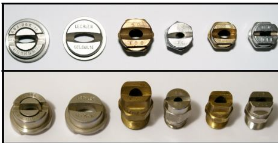
Figura 3.3 – Alguns tipos de bicos VEEJET usados para resfriamento de cilindros da laminação a quente.
