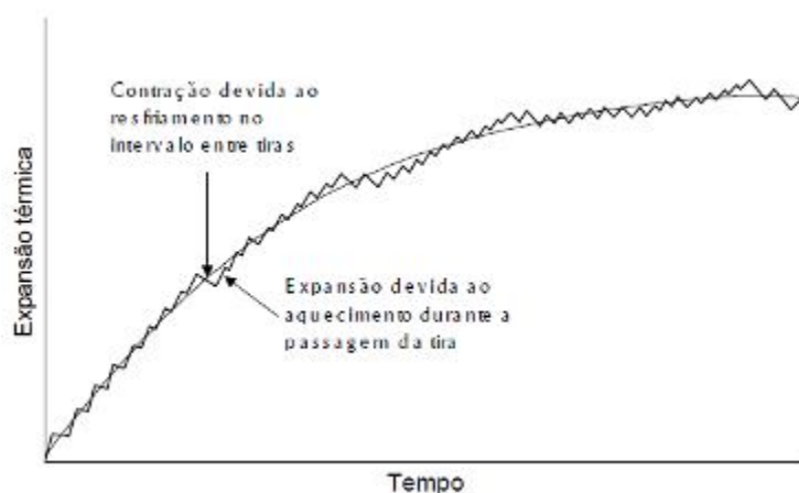
Figura 3.16 – Evolução da expansão térmica em função do tempo decorrido em um ciclo de laminação, CHAMONGE (17) .
