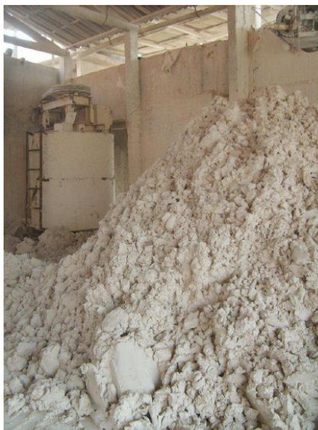
FIGURA 2.15 - Torta de caulim filtrada
