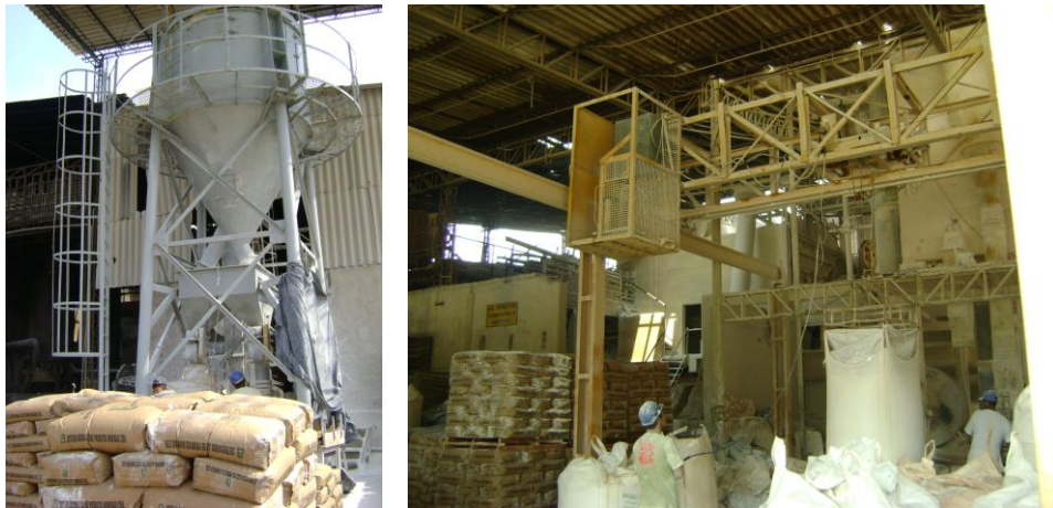
FIGURA 2.17 - Aerosseparador e caulim pronto para ser comercializado.
