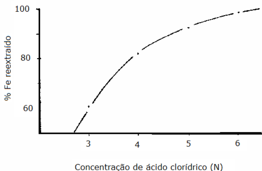
FIGURA 4.5 - Efeito da concentração de ácido clorídrico na reextração de ferro. Condição: tempo de contactação = 10 minutos.
