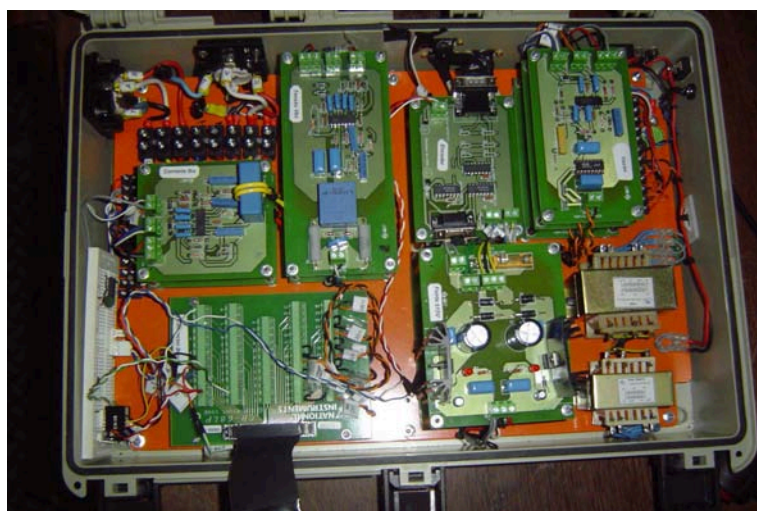
Figura A.1: Foto da caixa contendo o hardware de condicionamento de sinais utilizado na monitoração das bancadas.
