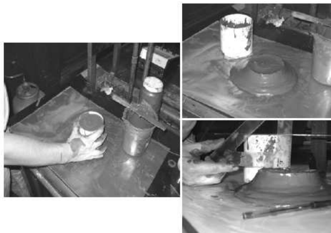
Figura 4.7 – Representação teste de “slump”. (Barreda, 2007).
