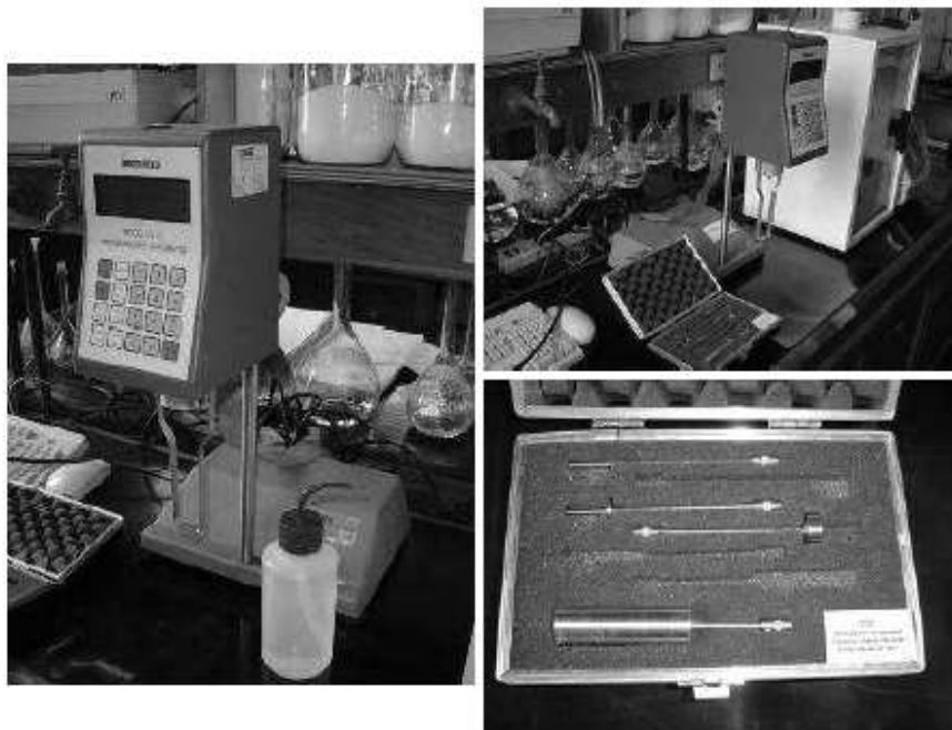
Figura 3.23 - Viscosímetro Brookfield modelo DV-III com os “spindles” LV-1, LV-2, LV-3 e LV-4.
