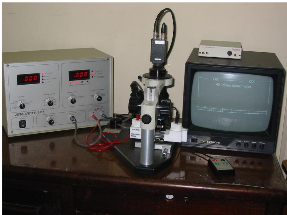
Figura 4.1: Aparelho de microeletroforese Zeta-Meter 3,0+.
