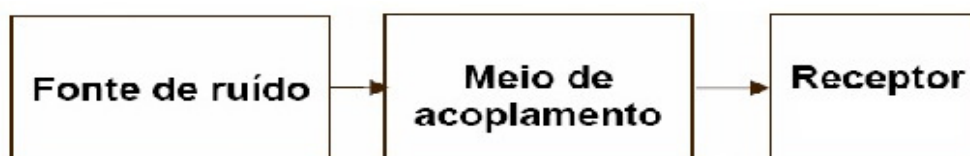
Figura 1 - Diagrama em blocos referente ao gerador, transmissor e à vítima da interferência
