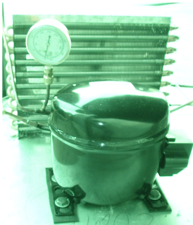
Figura 3.13 – Compressor (bomba de calor) e ao fundo o Evaporador Convencional
