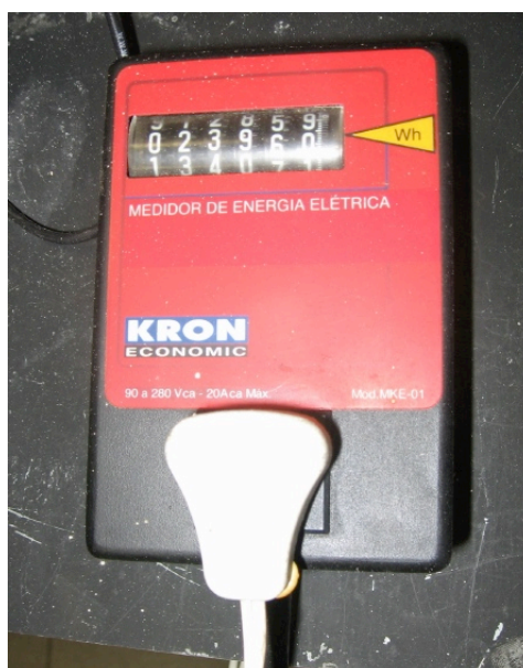
Figura 3.3 - Medidor de energia.
