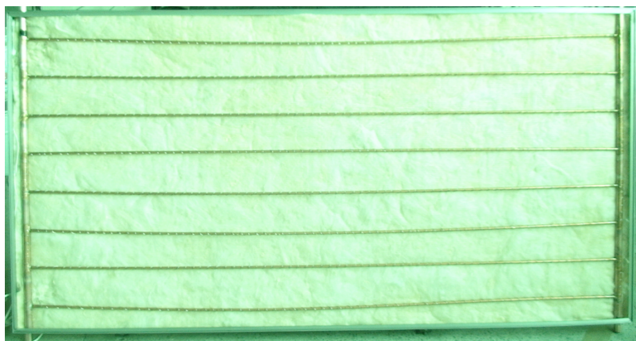
Figura 3.15 – Placa do coletor solar enrolada com resistência elétrica para simular o efeito termossifão.
