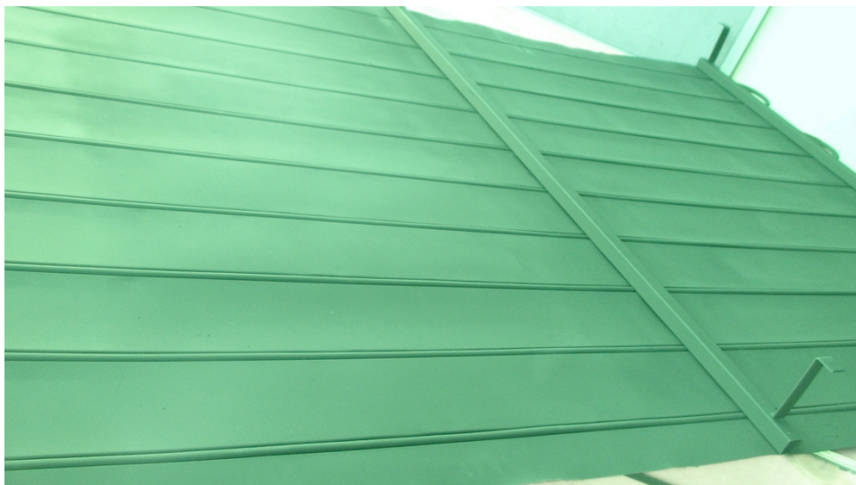
Figura 3.11 – Evaporador estático construído
