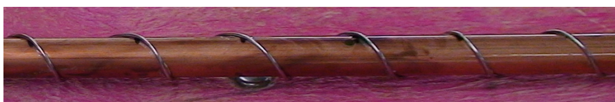
Figura 3.16 – Resistência elétrica enrolada no tubo de cobre do coletor solar para simular o efeito termossifão.
