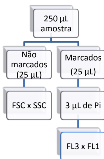
Figura 5: Esquema demonstrativo do processamento das amostras sanguíneas para aquisição em citômetro de fluxo.
