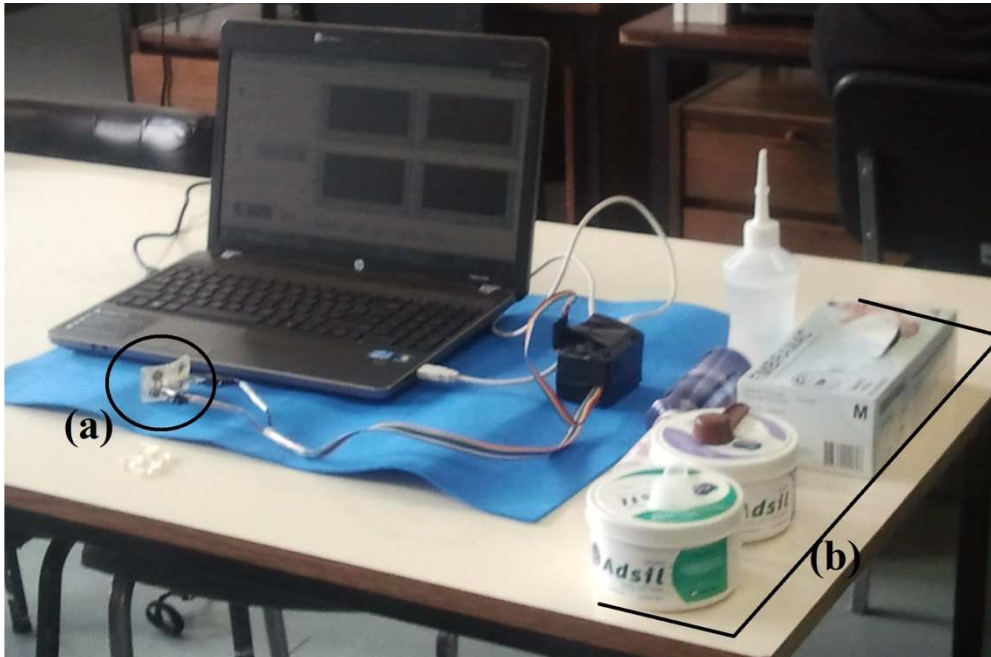
Figura 23 – Equipamento montado, sendo (a) sistema mecânico acoplado aos sensores e (b) material utilizado para confecção do mordedor
