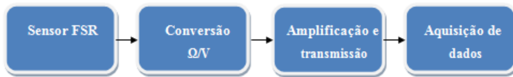
Figura 19 – Sistema de condicionamento do sinal
