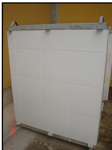
Figura 3.36 Vista de painel revestido com peças cerâmicas e rejuntado
