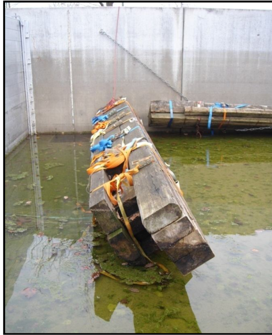
Figura 3.29 Peças madeira para realização de ensaios de resistência ao impacto nos protótipos das medidas de proteção. Laboratório de ensaios de protótipos do Instituto Wasserbau (Fotografia: Cristiane Parisi Jonov, 2011)
