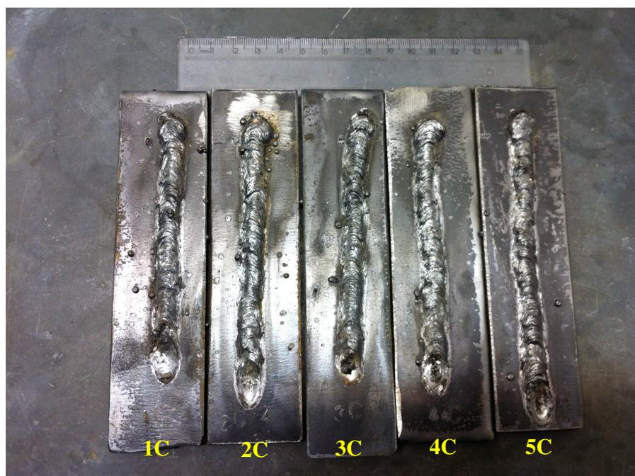
Figura 4.3 - Cordões obtidos com eletrodo E7018
