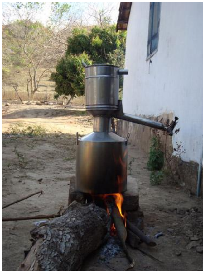
Figura 14 - Aparelho utilizado pelo Coletivo de Cuidadoras para destilar os remédios à base de plantas medicinais
