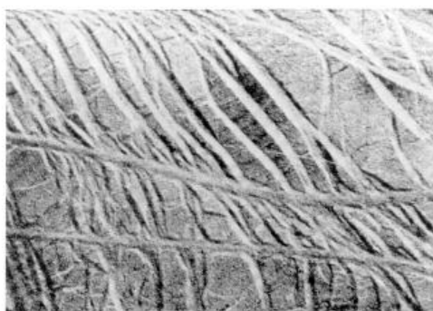
FIGURA 3.4- Bandas de Lüders em uma chapa de aço 1008 estampada
