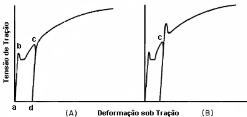
FIGURA 3.1-. Envelhecimento por deformação (A). A carga foi removida do corpo de prova no ponto c e o recarregamento foi feito após um curto intervalo de tempo (horas) . (B) A carga foi removida no ponto c e recarregado após um longo período de tempo
