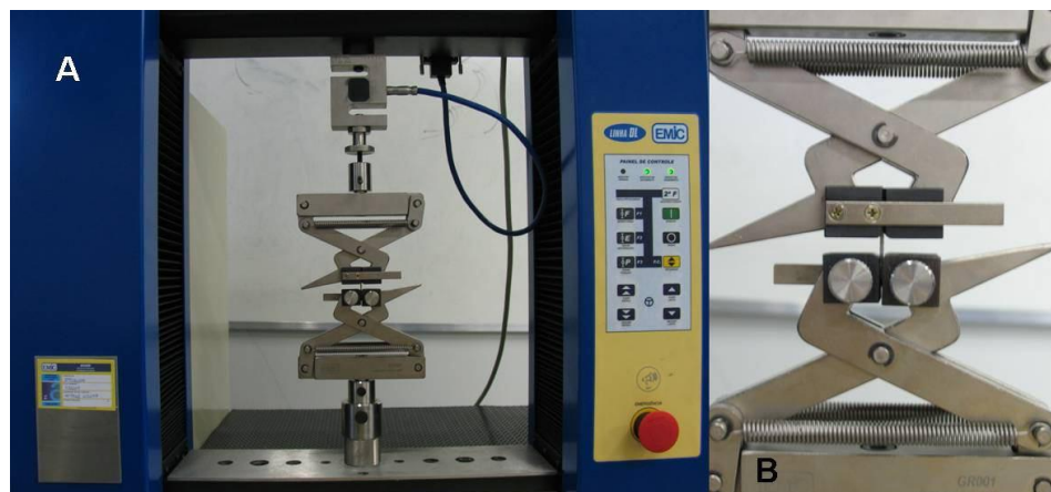
FIGURA 3.1 – Ensaio de tração. A – Máquina de ensaios EMIC DL-10000; B – Garras autotravantes para polímeros com corpo de prova posicionado (TAVANO, 2010).
