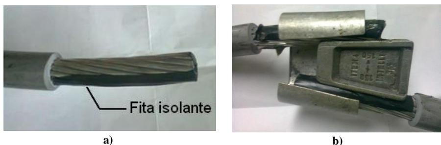
Figura 3.4 – a) Cabo coberto por camada de fita isolante, b) Conexão cunha defeituosa
