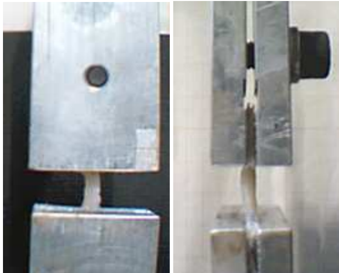
Figura 5.6 – Amostra 03 de mucosa humana sob ensaio de tração.
