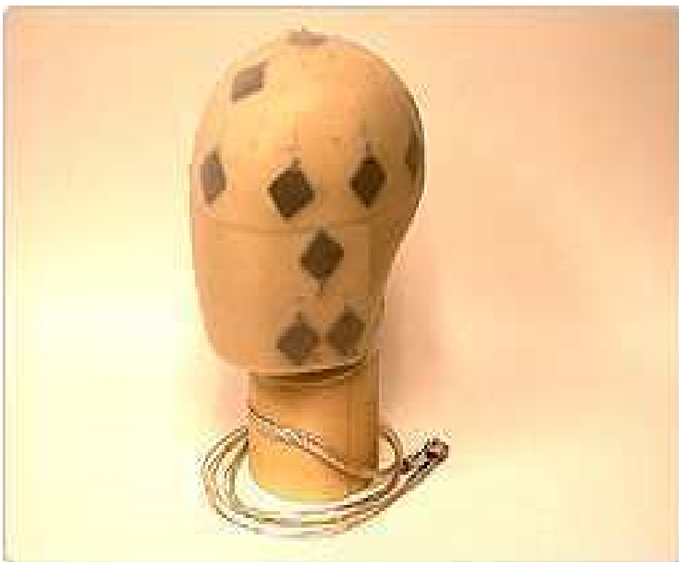
Figura 6.1 - Aplicação do sistema PPS para medições de pressão na cabeça.
