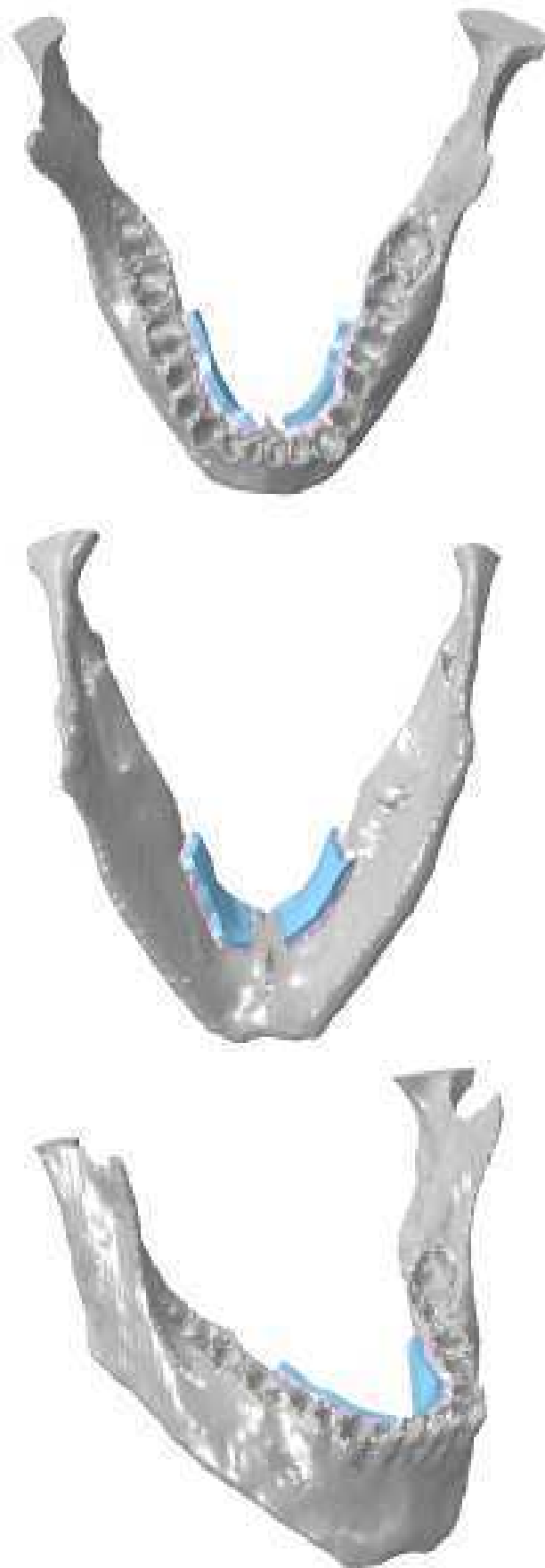
Figure 7.9 - Modelo sólido da mandíbula com a parte acrílica do aparelho – Paciente B (SolidWorks®).
