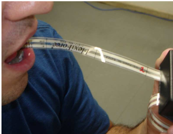
Figura 6.13 - Medições de forças utilizando aparelho expansor mandibular.
