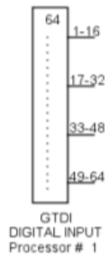
Figura 4.17 – Componente de leitura das entradas digitais do cartão GTDI – rtds_risc_ctl_GTDIINP2
