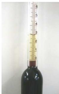
Figura I.1 – Butirômetro de leite com amostra evidenciando a fração lipídica e a escala percentual
