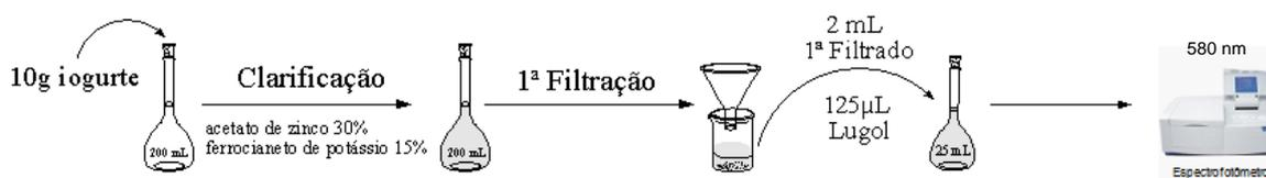
Figura III.2 – Método desenvolvido para quantificar a perda de amido no 1º filtrado do método IN 68/2006 MAPA
