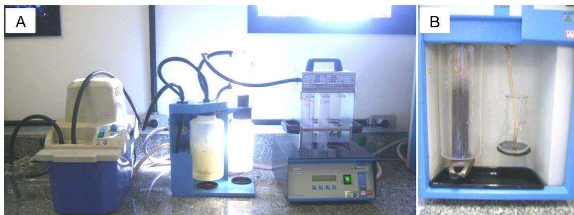
Figura II.2 – Bloco digestor (A) e destilador de amostras de alimentos (B) para análise de proteínas
