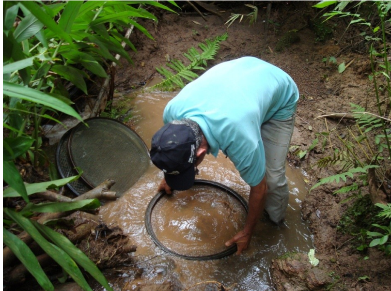
Figura 2.2: Trabalho de peneiramento para concentração dos minerais indicadores in-situ .
