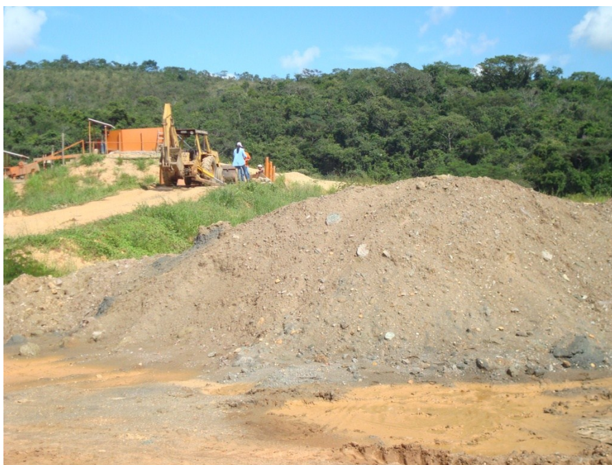
Figura 7.5: Material kimberlítico fragmentado obtido na trincheira do Ponto 2 preparado para tratamento na planta de beneficiamento da GAR Mineração Ltda, ao fundo.
