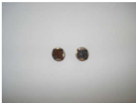
FIGURA 6.90: Debris correspondentes ao primeiro estágio de desgaste - \mu oscilatório (esquerda) e segundo estágio de desgaste (direita) (foto digital).
