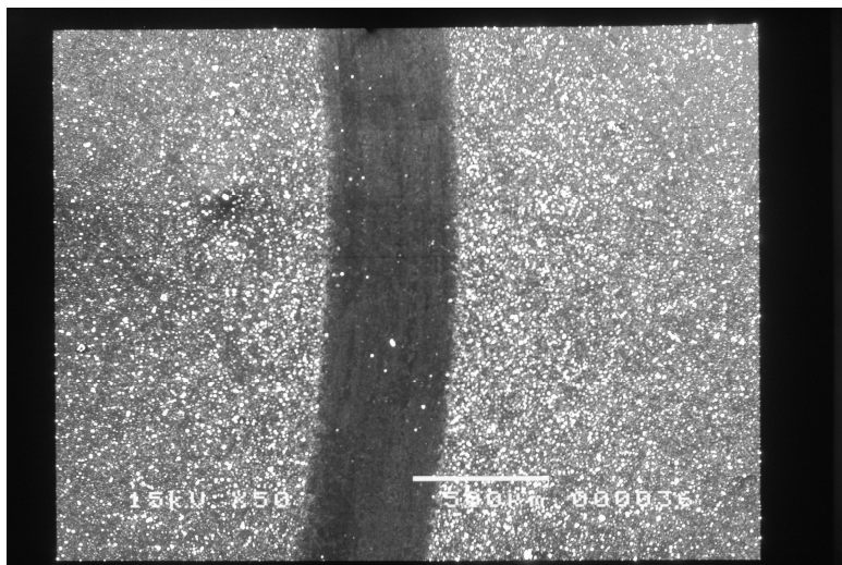
FIGURA 6.101: Imagem por MEV da trilha de desgaste do sistema duplex carbonetado (50X – SEI).
