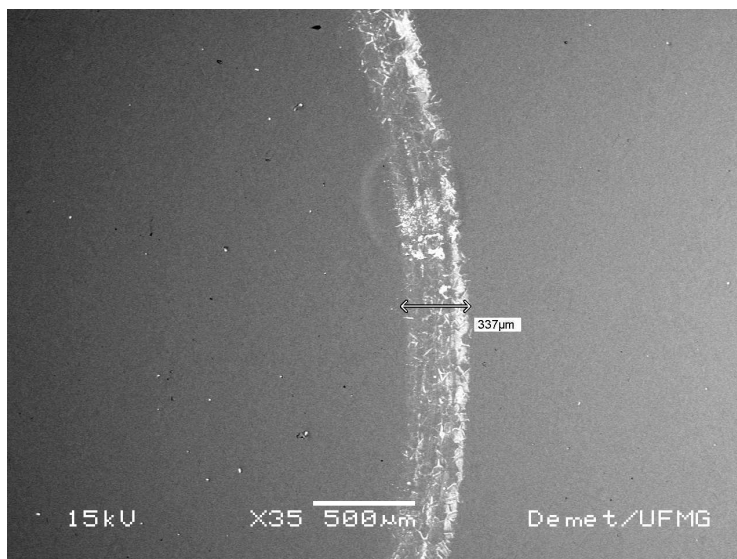
FIGURA 6.75: Trilha de desgaste do sistema duplex sequencial (35X – BEI).
