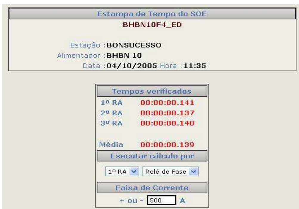
Figura 4.4.13(b) – Tempo de Abertura e Fechamento do Disjuntor
