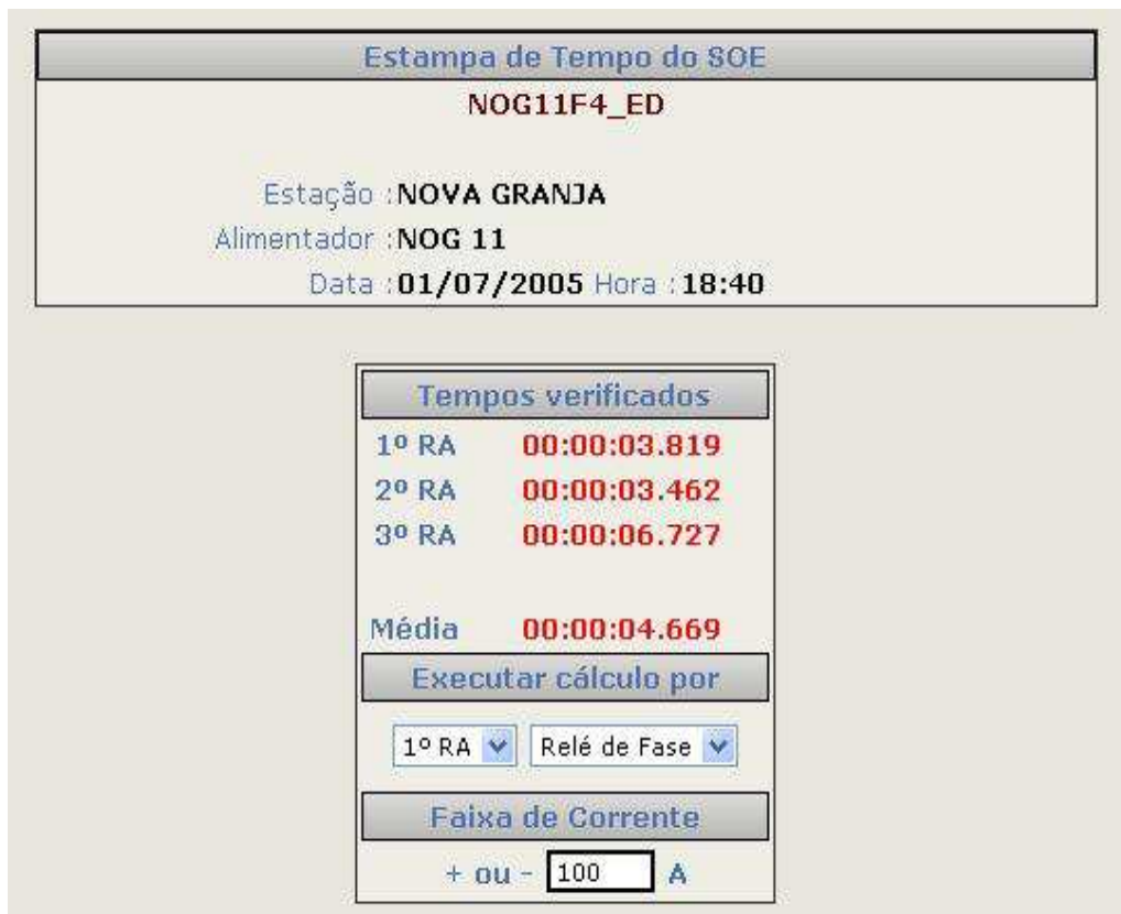
Figura 4.3.12(b) – Tempo de Abertura e Fechamento do Disjuntor
