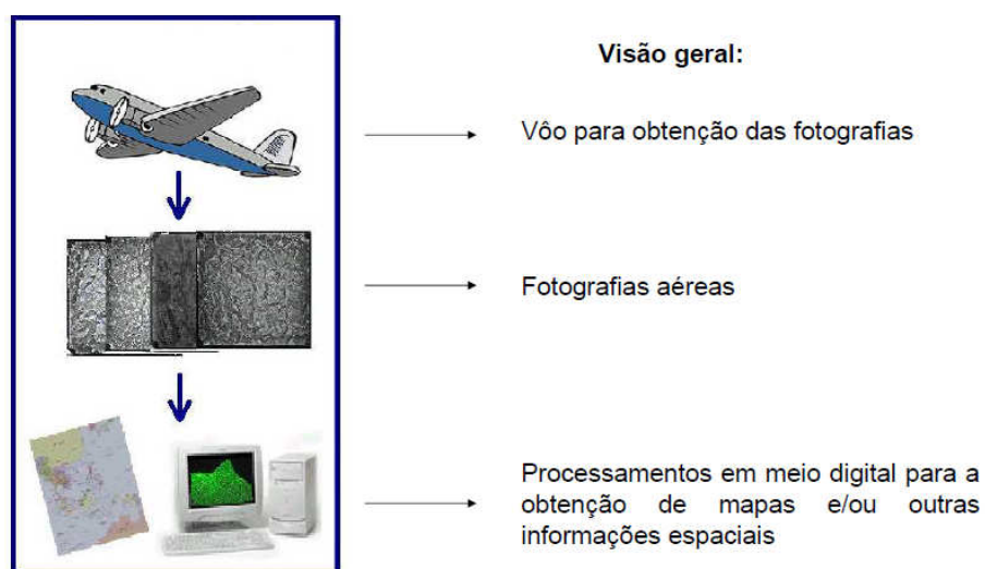
FIGURA 4 – Etapas de levantamento aerofotogramétrico
