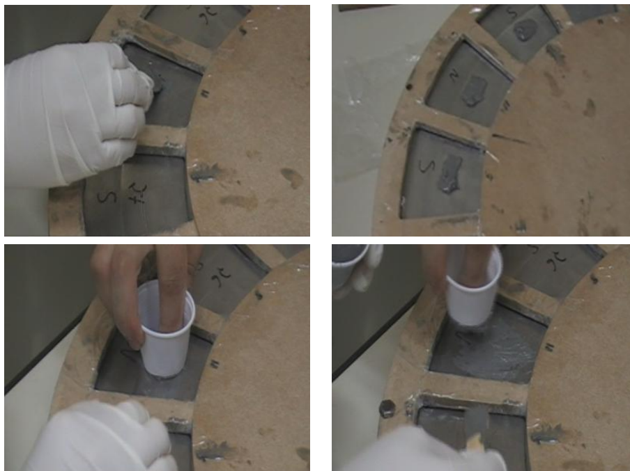
Figura 4.57: Processo de aplicação da araldite na peça de rotor
