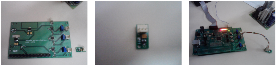
Figura B.1: Circuito de medição de fluxo desenvolvido para a montagem do gerador
