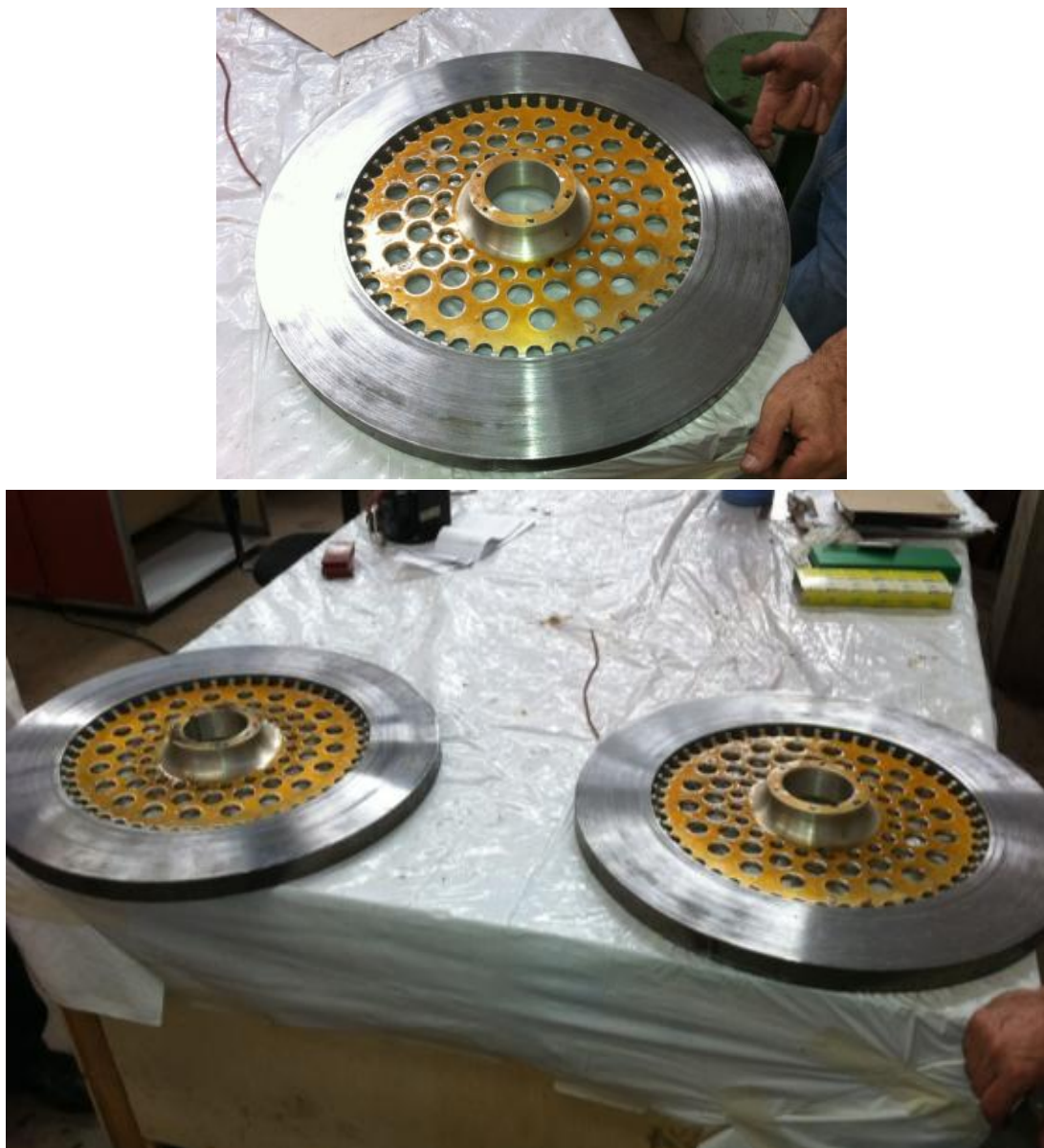
Figura 4.33: Imagem dos peças de estator sem bobinas de cobre
