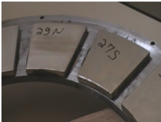
Figura 4.61: Resultado final da curagem de um lado dos ímãs
