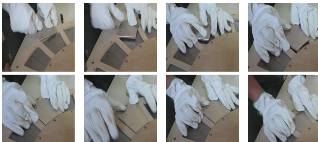
Figura 4.54: Procedimento de teste para alocação dos ímãs na peça de rotor
