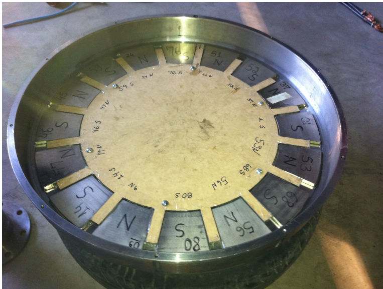
Figura 4.67: Foto dos rotores externos com os ímãs colados
