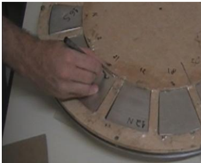
Figura 4.59: Reidentificação das polaridades nos ímãs
