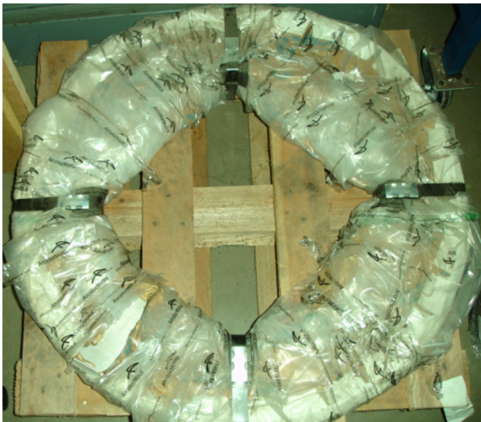
Figura 4.21: Fita de aço silício E110 protegida
