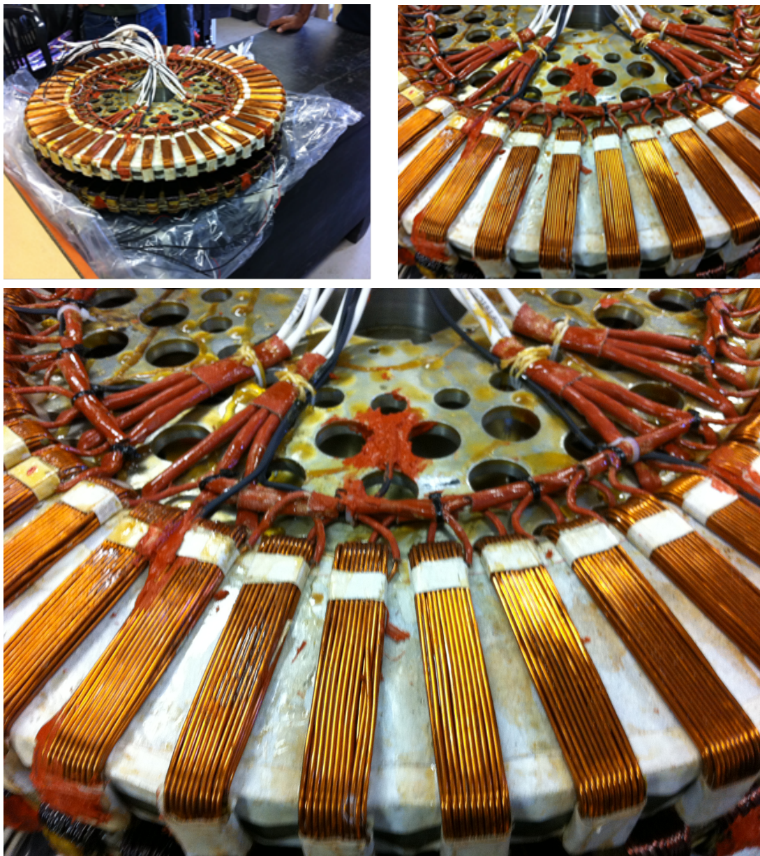
Figura 4.41: Estatores bobinados e prontos para montagem
