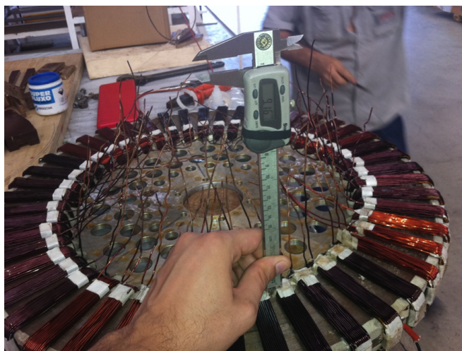
Figura 4.39: Medições no estator após primeiro processo de bobinamento
