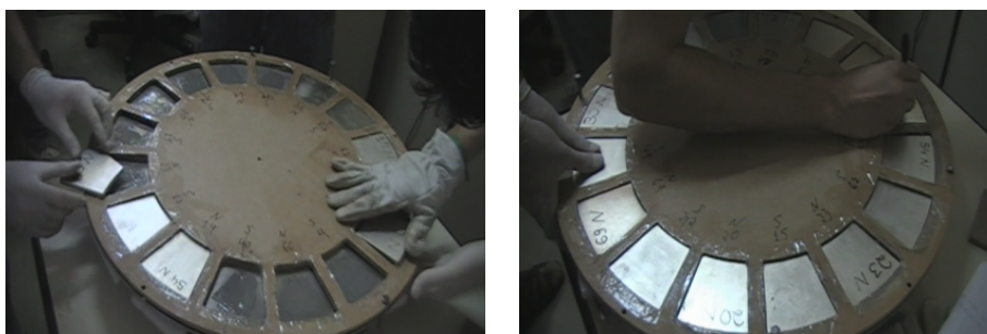
Figura 4.62: Fim do processo de colagem dos ímãs no segundo lado do rotor
