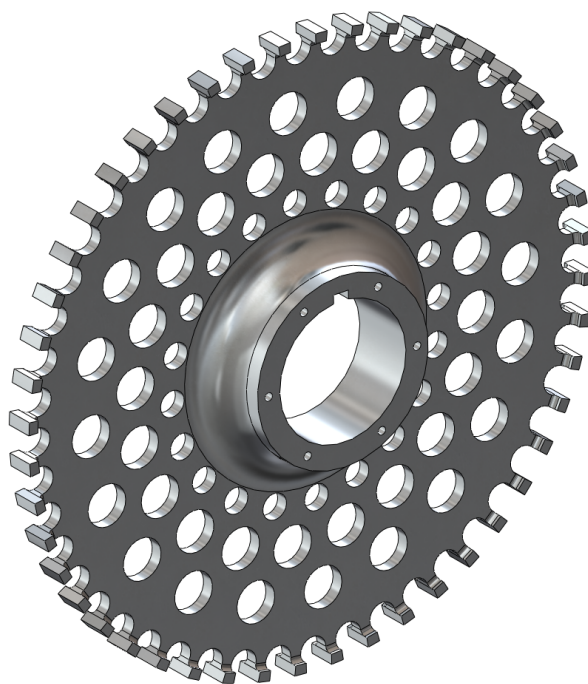
Figura 4.6: Modelo 3D da coroa do estator
