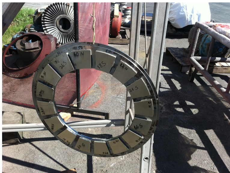
Figura 4.63: Secagem da peça de rotor após aplicação de resina
