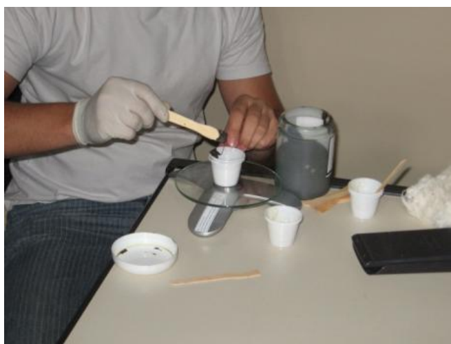
Figura 4.56: Pesagem e mistura da araldite com o endurecedor
