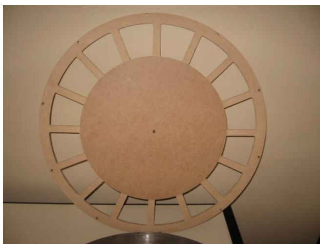
Figura 4.52: Gabarito de madeira para montagem dos ímãs na peça de rotor
