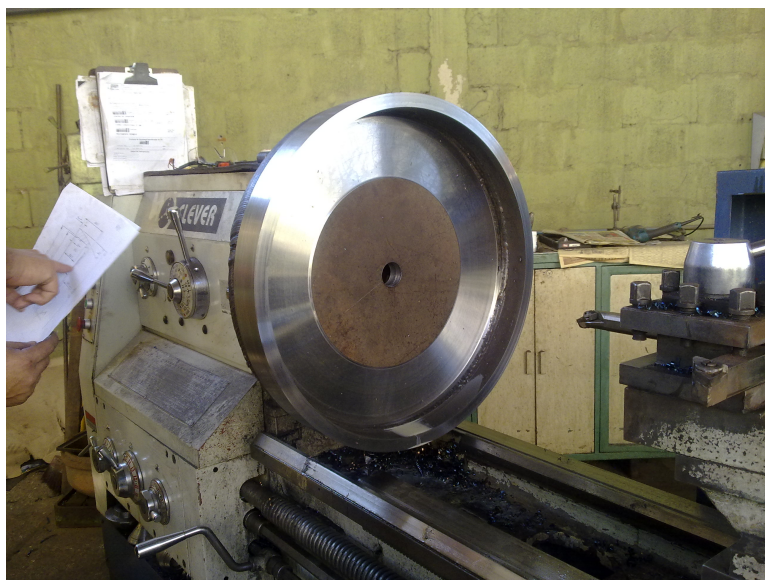
Figura 4.65: Usinagem dos rotores externos
