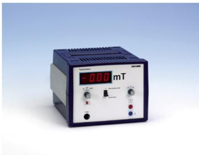
Figura 4.43: Equipamento utilizado para medição da densidade de fluxo
