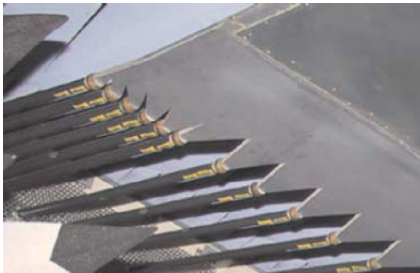
Figura 2.19 – Detalhe da terminação resistiva em uma das extremidades do condutor interno [Thye, Armbrecht and Koch, 2009].
