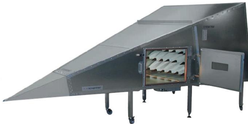
Figura 1.1 – Célula GTEM com a porta lateral aberta mostrando os absorvedores.
