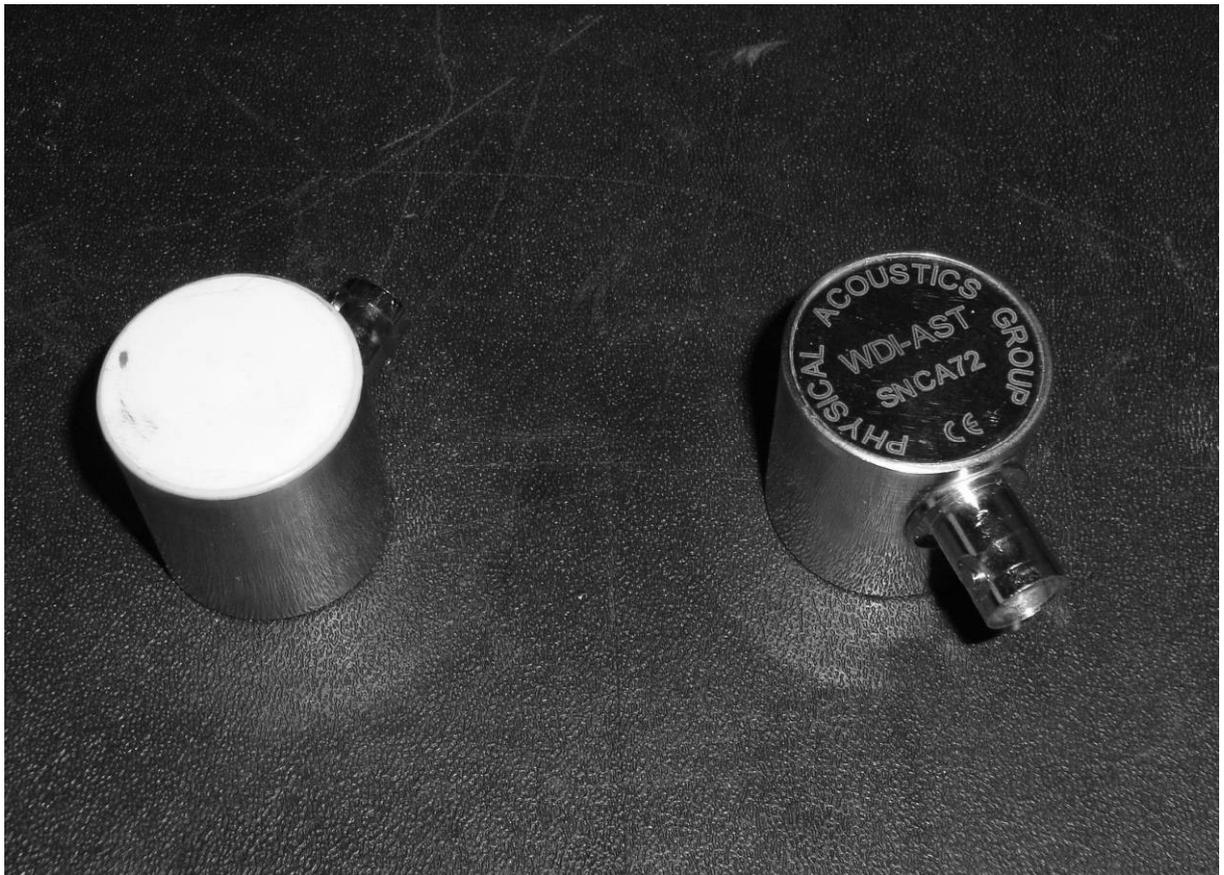
FIGURA B.3 – Sensores WDI-AST utilizados nos ensaios
