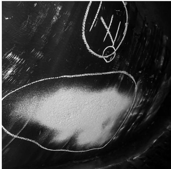
FIGURA 5.15 – Pá com erosão por cavitação da unidade geradora 05
