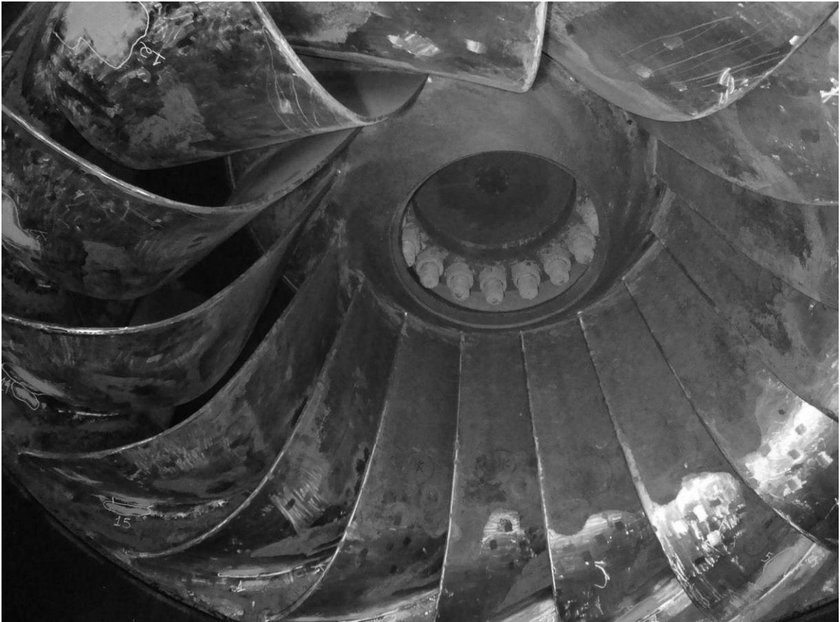
FIGURA 5.14 – Rotor da turbina da unidade geradora 03 com as áreas mapeadas.
