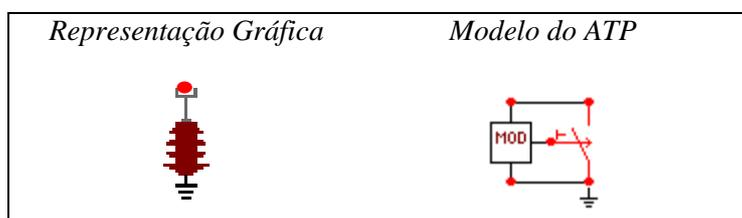
Figura 4.10 – Modelagem dos isoladores no ATP.
