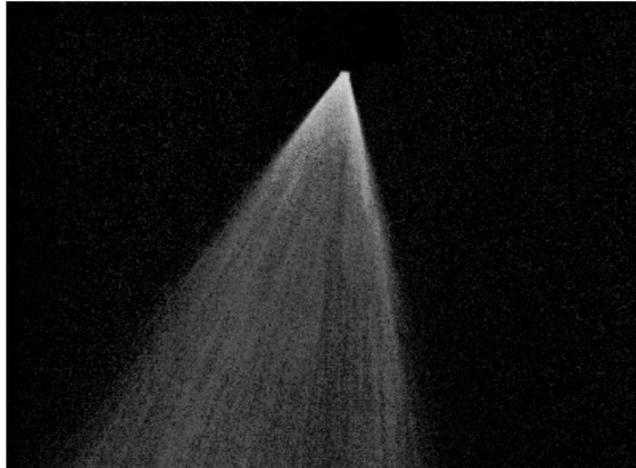
Figura 4.21- Subtração de uma imagem com spray de gasolina com outra sem spray.
