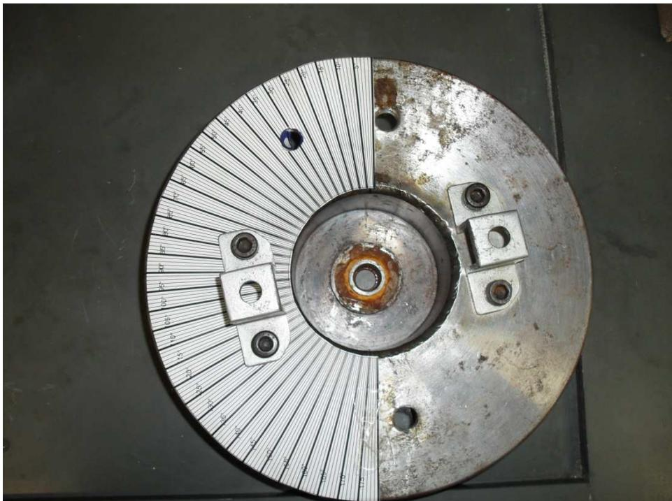
Figura 4.10 - Escala para medição dos ângulos no flange superior da câmara de acrílico.
