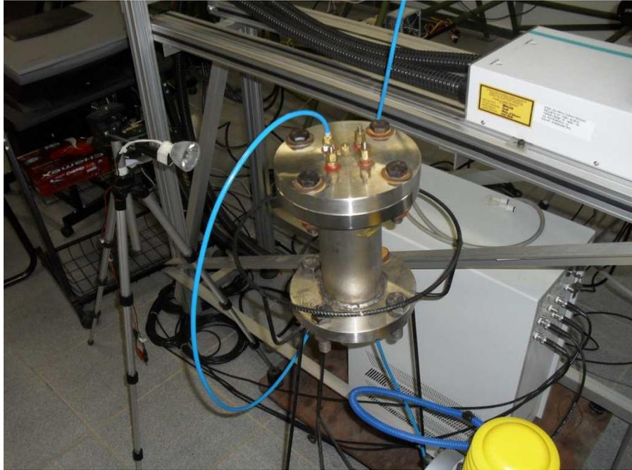
Figura 4.7 - Vaso de pressão utilizado nos experimentos.
