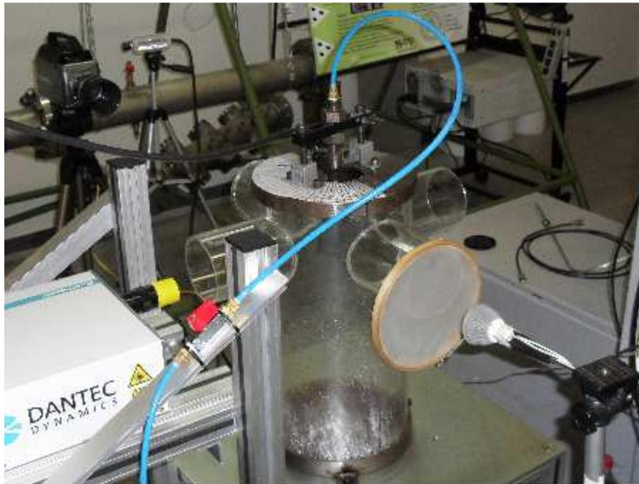
Figura 4.6 - Posições relativas da câmera e iluminação.
