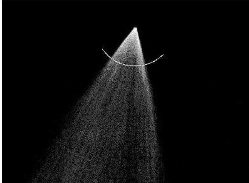
Figura 5.12 - Posições dos pixels situados a uma distância de 0,70 cm do spray de gasolina em uma imagem obtida a alta frequência após tratamento.
