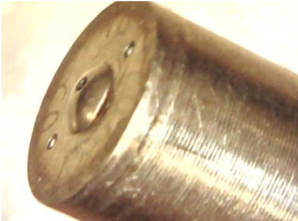
Figura 4.5 - Detalhe do orifício do injetor.
